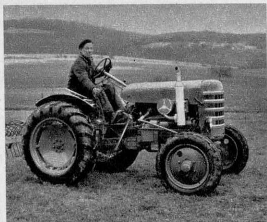
Tracteur Labourier type LD 25 L; diesel bi-cylindre de 30 ch à refroidissement à eau. Les voies avant et arrière sont réglables depuis 1,10 m jusqu'à 1,55 m.
