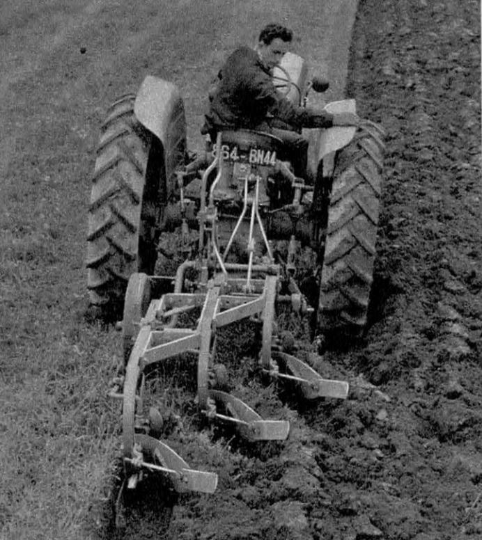
**Deux moteurs différents** peuvent équiper ce type de tracteur : soit un diesel de 38 ch, soit un moteur à essence ou gasoil qui donne 36 ou 33 ch suivant le cas. On peut encore choisir entre les roues, les demi-chenilles (seulement à l'arrière) ou les chenilles complètes. Des adaptations existent pour le travail du houblon, des vignes et des vergers. Ci-contre, coupe du tracteur équipé du moteur essence-gasoil.
