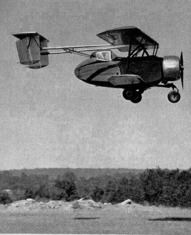
← **UN AVION SPÉCIFIQUEMENT AGRICOLE,** le PL 7 «TANKER» de la Kingsford Smith (Australie). Il peut être employé aussi bien pour la pulvérisation de liquides insecticides que pour l'épandage d'engrais.
