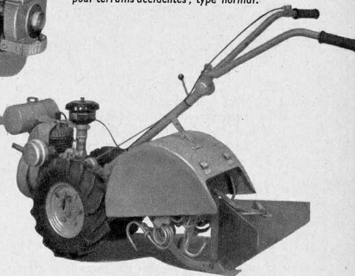
« **JUNIOR** » MABEC 2 ch, deux roues, avec fraise et volet de buttage : un système de roue libre permet le pivotement sur place de l'ensemble.
