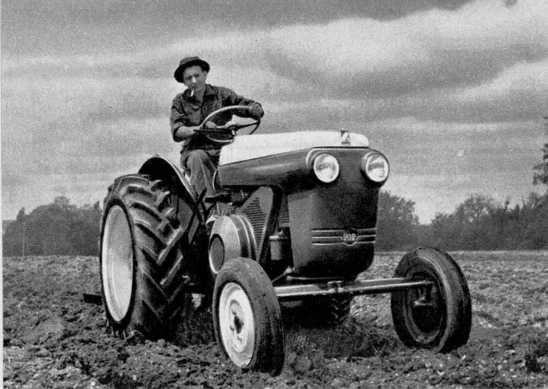
sont, le plus souvent, seules motrices, mais il existe aussi des tracteurs équipés de quatre roues motrices. Ces roues munies de pneumatiques spéciaux offrant, d'une part, des saillies accrochant le sol et, d'autre part, une forte surface de contact avec le sol, posent de grands problèmes aux constructeurs pour répartir entre elles le poids total du matériel.
