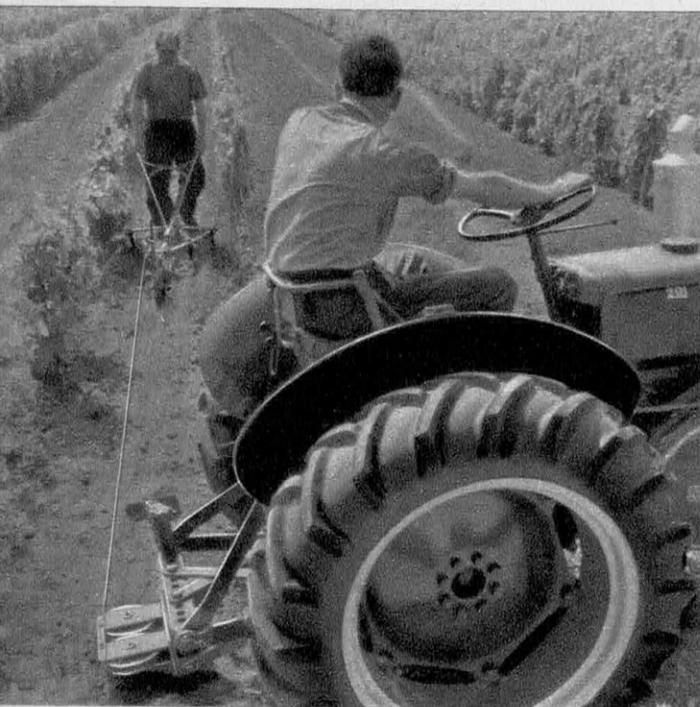
← **Le tracteur S F V type 201** comporte un treuil spécial qui lui permet d'effectuer des labours dans les vignobles en pente et dont l'écartement des rangs est inférieur à 1 mètre. Le treuil est ici équipé d'une charrue vigneronne.
