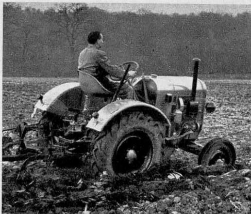
**Tracteur Eicher** diesel importé par L. Bara. Il se fait en 7 modèles, d'une puissance allant de 15 à 60 ch. Sa faible consommation lui a valu le prix Max Eiht.
