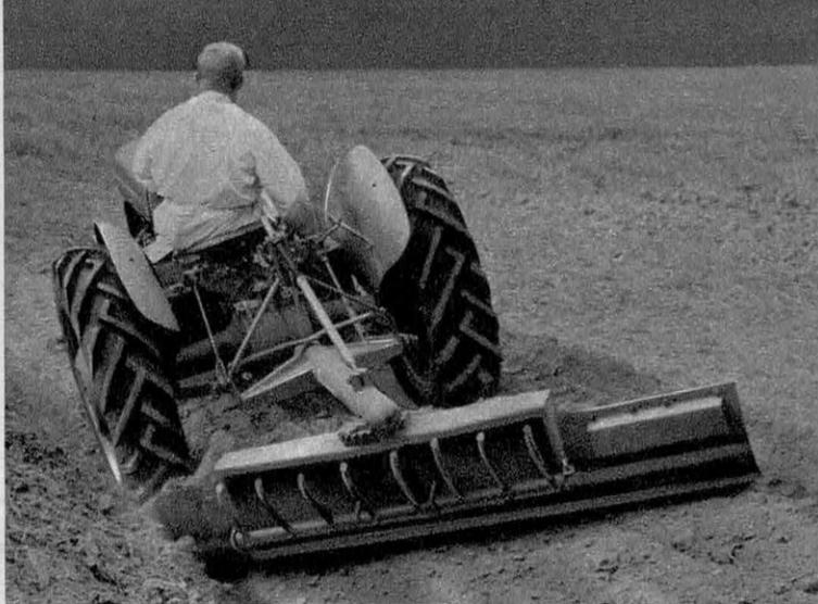
← **Les tracteurs Massey-Harris** peuvent, en plus de nombreux outils agricoles, être munis, comme celui ci-contre, d'une lame de nivellement qui les transforme en engins de « travaux publics » souvent aussi utiles dans les champs que dans les chemins de déserte ou dans la cour de la ferme. La gamme des tracteurs est elle-même très variée.
