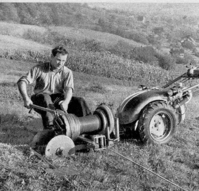
← **Le treuil** qui équipe cette « Record » (Kuhn) peut être dirigé dans le sens de marche de la machine et servir à la hisser vers un point fixe, permettant ainsi de cultiver les terrains les plus accidentés.
