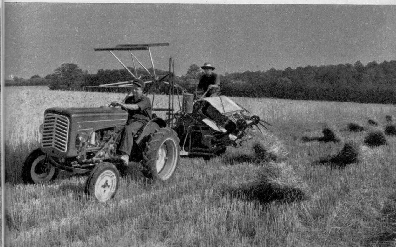
Le 35 ch diesel, refroidi par air
