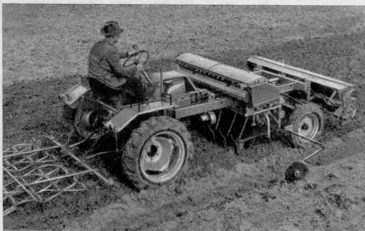
**Le Multitrac Güldner 17 ch** (diesel-air) de chez Hortex traduit une conception nouvelle de la motorisation agricole. C'est non seulement un tracteur mais aussi un porte-outils qui permet, comme ici, de combiner plusieurs opérations : distribution des engrais, ensemencement et hersage. Le montage des divers instruments est d'une grande facilité.
