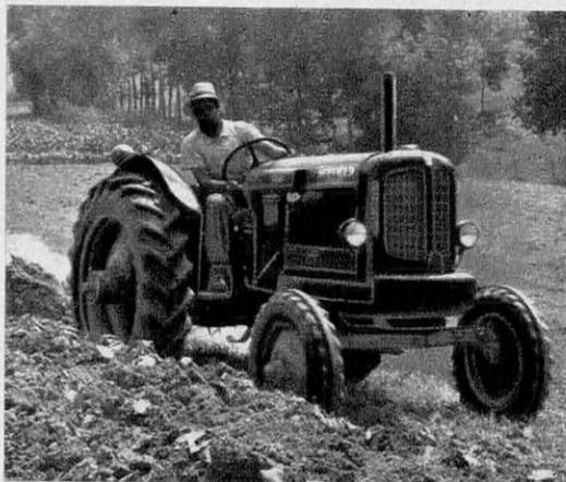
**Tracteur Nuffield** type DM 4; diesel 4 cyl., 4 temps de 46 ch. Voies réglables de 1,35 m à 2,25 m; 5 vit. avant et 1 vit. arr. Importé par Bergerat-Monnoyeur.
