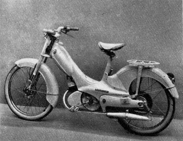
LE 50 CM 3 « RHONSONNETTE » à moteur VAP ; son châssis est en alliage léger et sa suspension arrière à blocs caoutchouc travaillant à la torsion.
