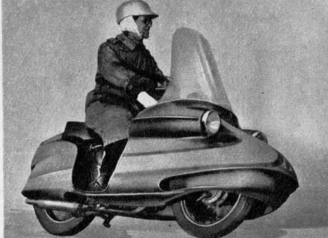
UNE RÉALISATION ANGLAISE de carénage en matière plastique sur moto de tourisme. La moto est une Royal Enfield « Bullet ». (Cliché Motor Cycle)
