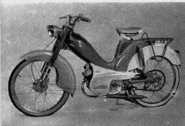
LA GAMME LUCER témoigne d'un réel éclectisme. Après l'Ondine à châssis monotube et carénage en matière plastique, voici le Triton à cadre embouti.
