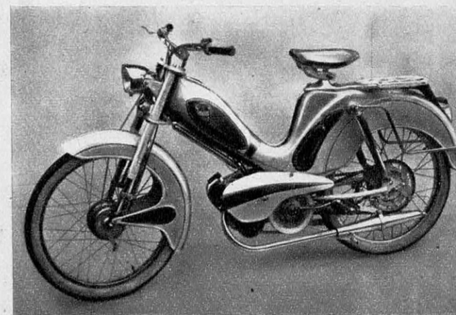
LE FOLLIS C 18 bis , également à moteur Lavalette, évolue vers le cyclo-scooter. La protection offerte par le châssis-caisson semble assez remarquable.
