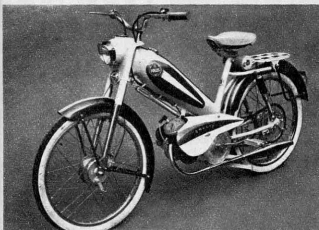
LE CYCLOMOTEUR FOLLIS C 102 à moteur Lavalette Multimatic et cadre-poutre formant réservoir. Le capotage du phare est net et élégant.
