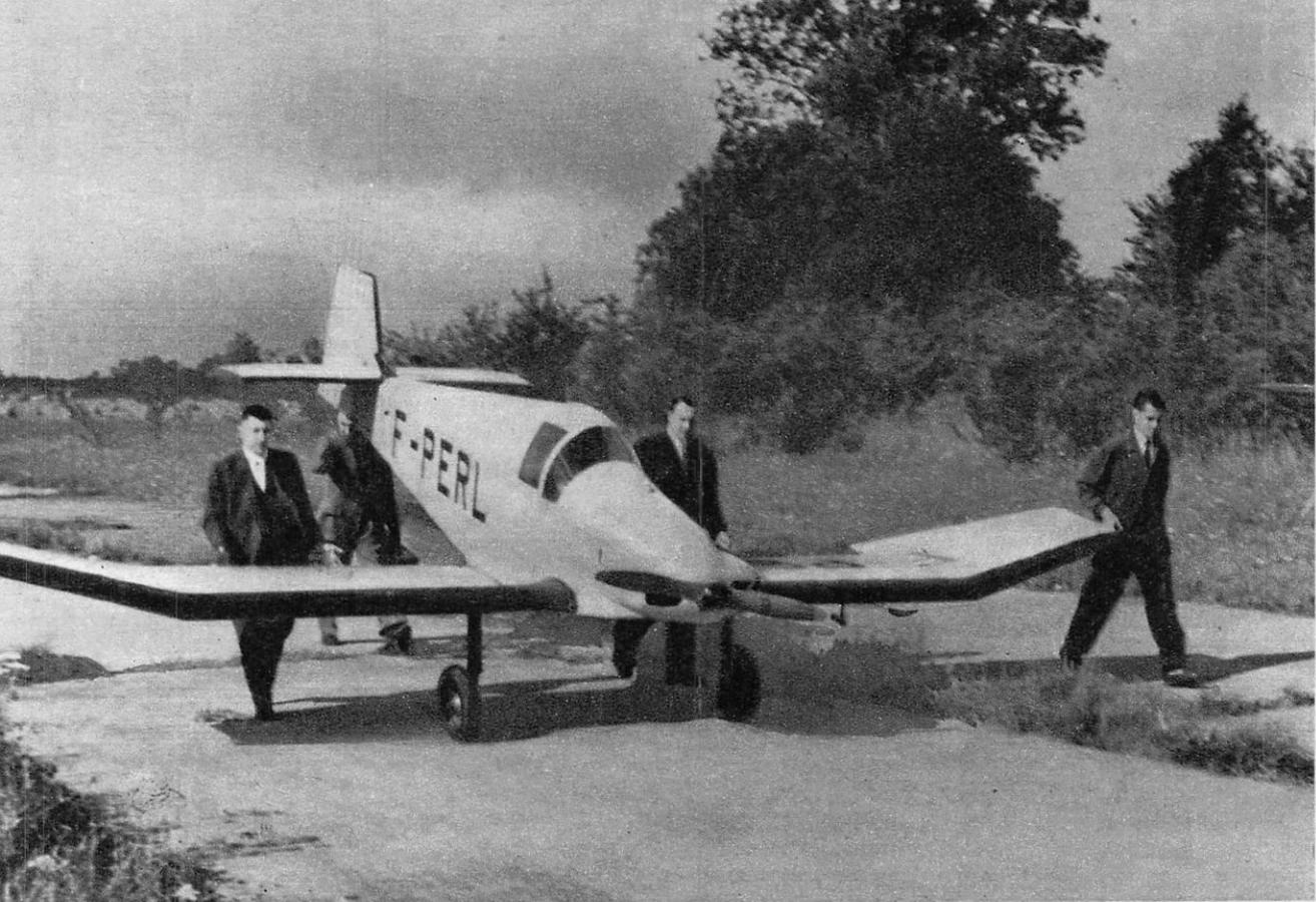
**LE BÉBÉ JOEL D-9** est le premier monoplace d'amateur qui ait connu un succès réel et durable. Il peut être équipé soit d'un moteur Volkswagen, soit d'un Dyna-Panhard, d'un Echard-Lutetia 4 C.02 ou encore d'un Sarolea. Très maniable, il décolle en 55 mètres, atterrit à 47 km/h et possède une autonomie de 400 kilomètres.
