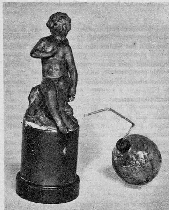
Pour les démonstrations de salon, les accessoires d'expérimentation se conformaient au goût du temps. On voit ici une bouteille de Leyde avec un conducteur en forme de figurine.
