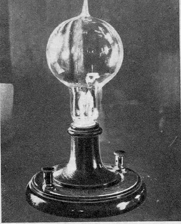
Le premier type de lampe à incandescence que créa Edison, après de longs et coûteux essais.
