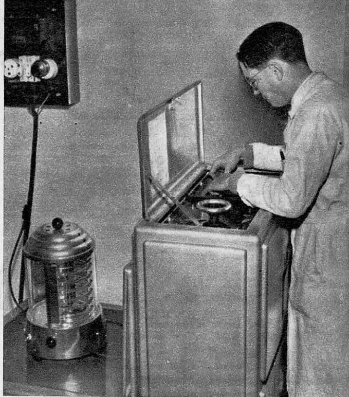
Rôtissoires et foyers de cuisson sont soumis à des essais d'isolement et de rendement.
