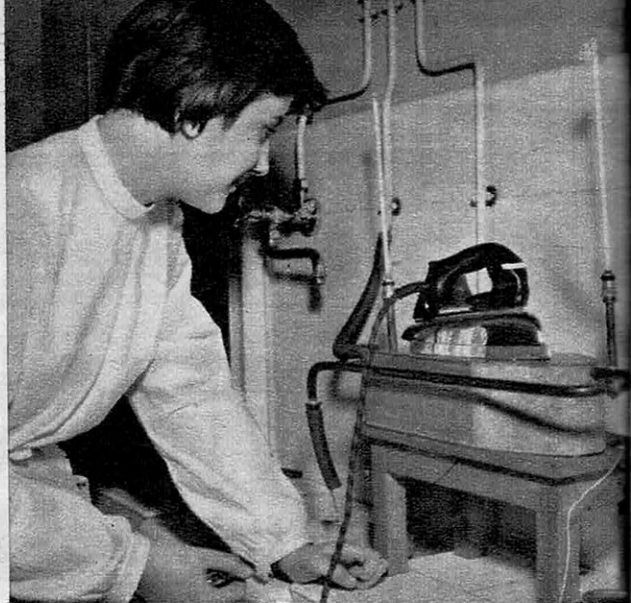
La mise en température des fers doit être rapide : 8 mn pour un fer de 1 kg et 250 W.
