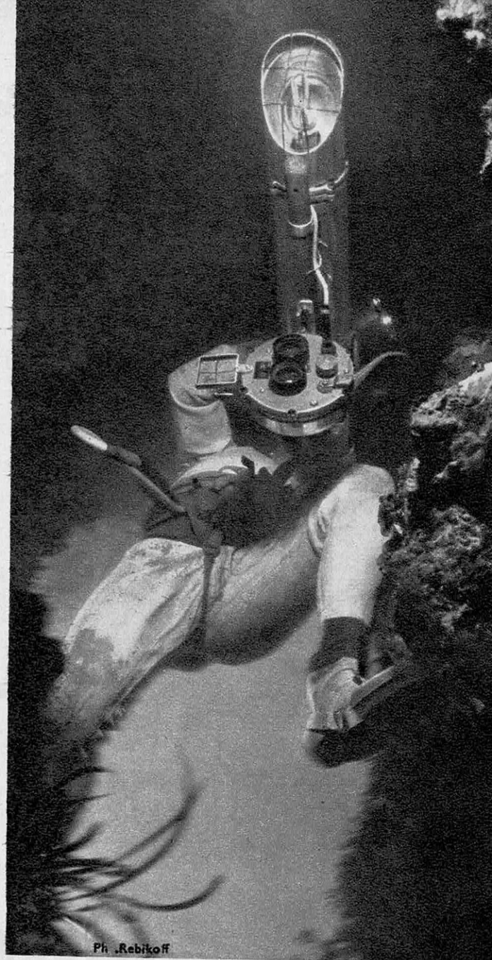
UNE EXPLORATION SOUS-MARINE à l'aide de la torpille Rebikoff associée ici à une chambre étanche Aquaphot pour l'appareil stéréoscopique Vérascope 40.
