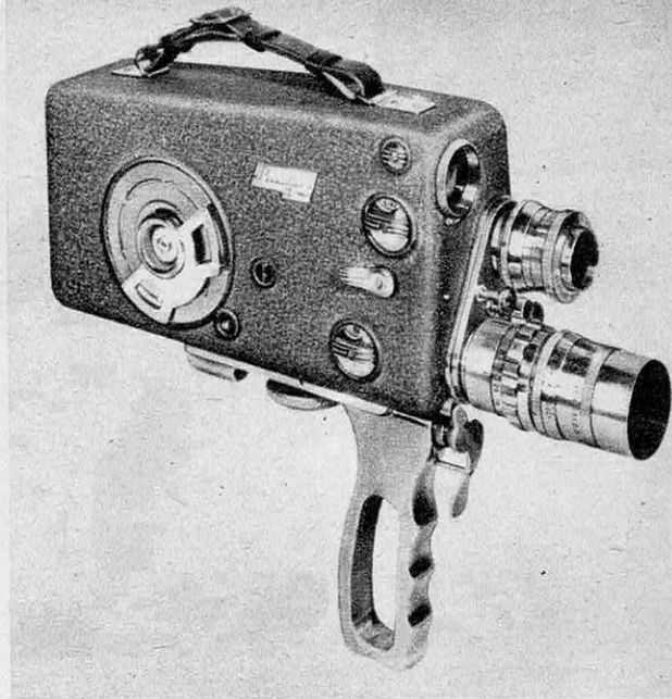
LA BEAULIEU T équipée d'une tourelle à deux objectifs peut recevoir les bobines de 15 ou 30 m, format 16 ou 9,5 mm. Viseur à correcteur de parallaxe. Vitesses de 10 à 64 images/s et fonctionnement vue par vue.
