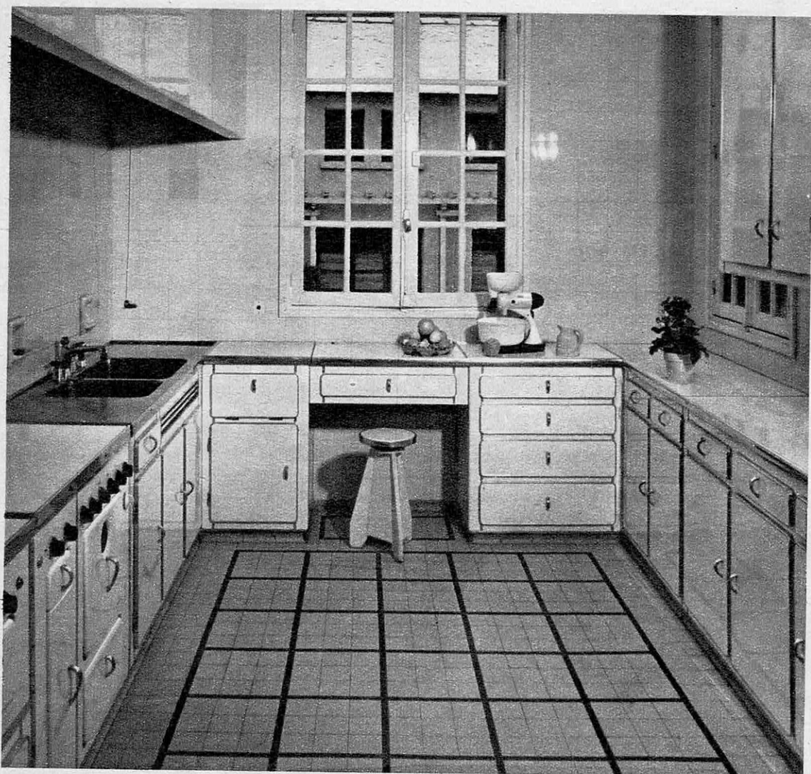
ENSEMBLE DE CUISINE avec cuisinière électrique et cuisinière à gaz, évier à deux cuves en acier inoxydable, meuble de préparation sous la fenêtre. A gauche : vide-ordures. A droite : tiroirs de rangement.
