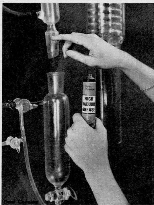
● Cette graisse de silicone spéciale est utilisée pour sceller et lubrifier les joints de l'appareillage de laboratoire où l'on doit faire un vide très poussé.
