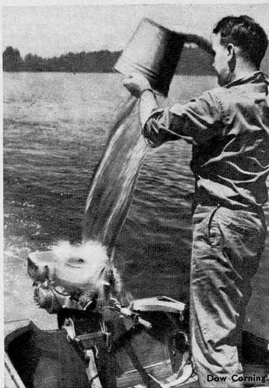
● Les isolants électriques de ce moteur hors-bord ont été hydrofugés par un vernis siliconé. Bien qu'on l'aspérge avec un seau d'eau, il ne tombe pas en panne.
