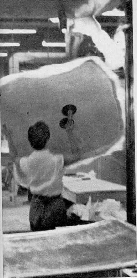
sous pression modérée. La pièce n'exige part l'ébarbage de la fibre en excès.
