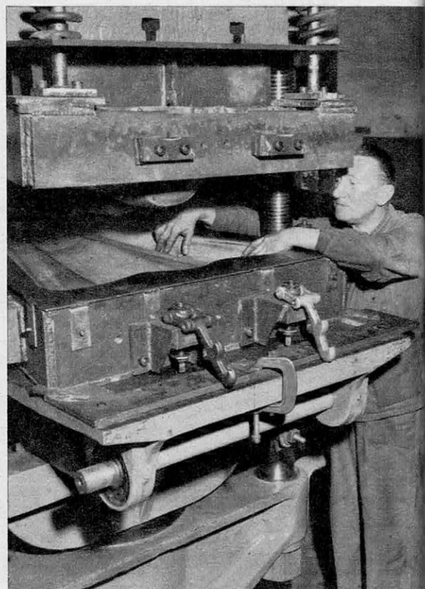
7 Le poinçon et la matrice sont placés sur une presse prête à emboutir un élément de la carrosserie.
