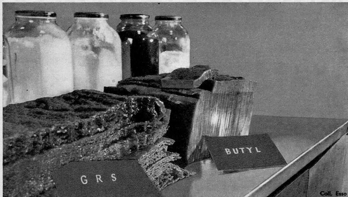
FEUILLES CRÉPÉES ET LATEX DE G R S, BLOC ET DISPERSION AQUEUSE DE BUTYL
