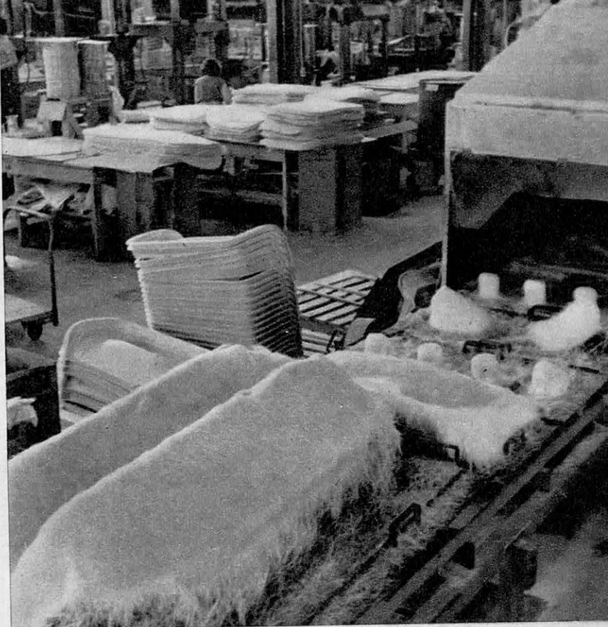
● Ici les préformes des pièces de petite dimension passent dans une étuve au gaz, prenant la consistance voulue avant d'aller sous les presses.
