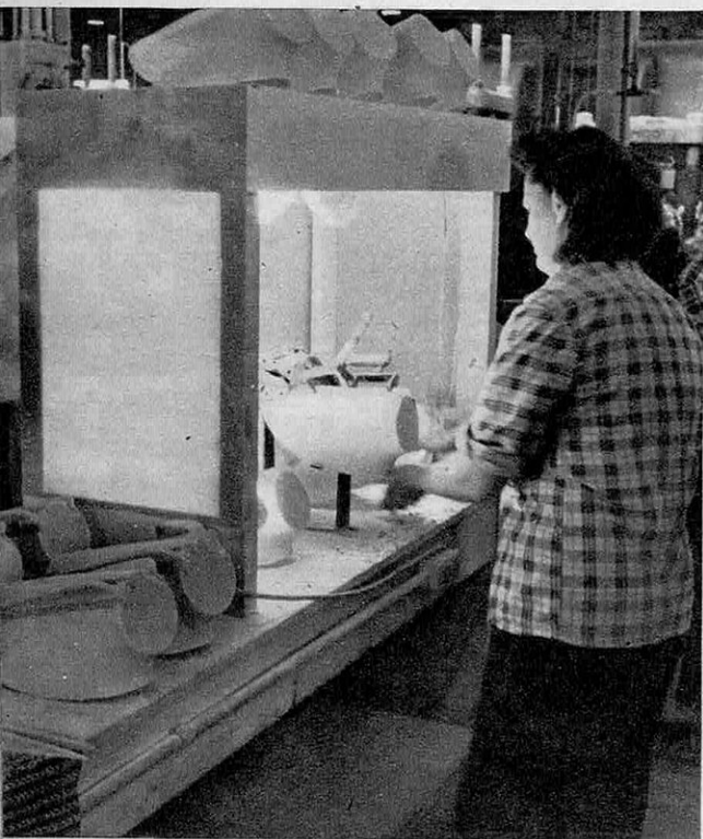
● La cuisson de la préforme peut s'effectuer aux infra-rouges : ici ce sera la dérive portant le feu arrière.
