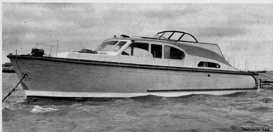
LA COQUE DU YACHT « PERPETUA », MOULÉE D'UNE SEULE PIÈCE, A 13,5 M DE LONG.
