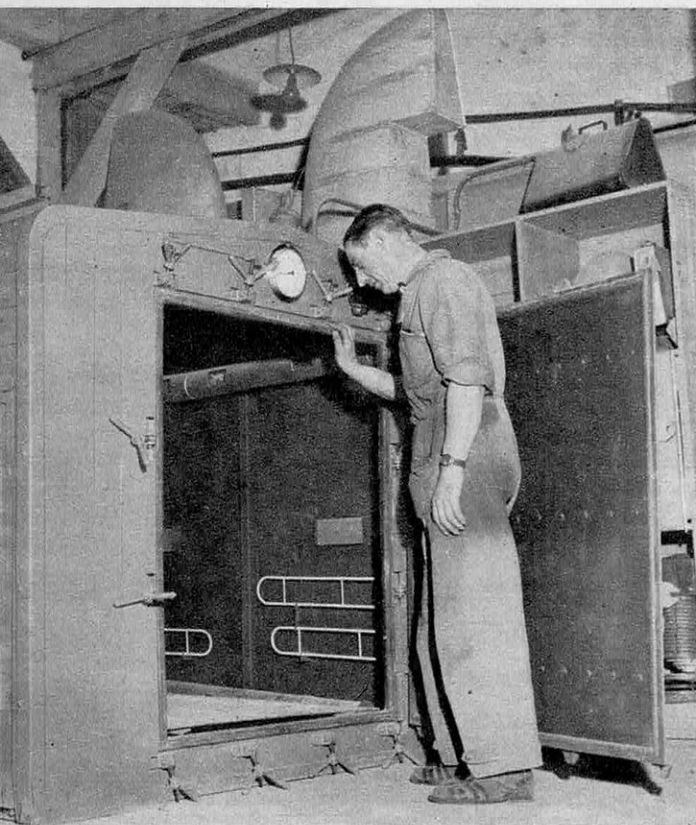
6 L'étuve à 80° dans laquelle va s'achever la cuisson des poinçons moulés avec la résine therm durcissable.
