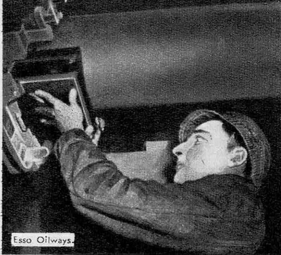
● Une briquette de graisse est appliquée contre le tourillon pour lubrifier un palier de locomotive.
