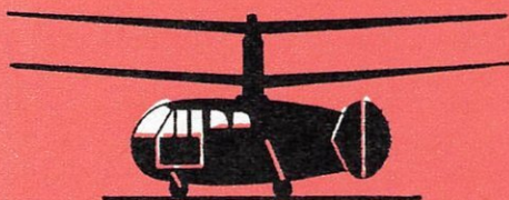
DEUX ROTORS COAXIAUX TOURNANT EN SENS INVERSE (Gyrodyne Modèle 2C)
