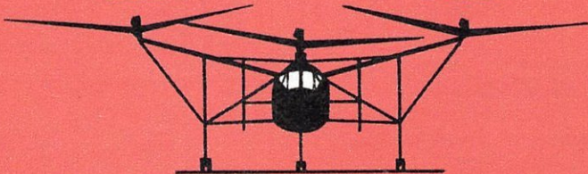
TROIS ROTORS A AXES DIVERGENTS (Cierva Air Horse)
