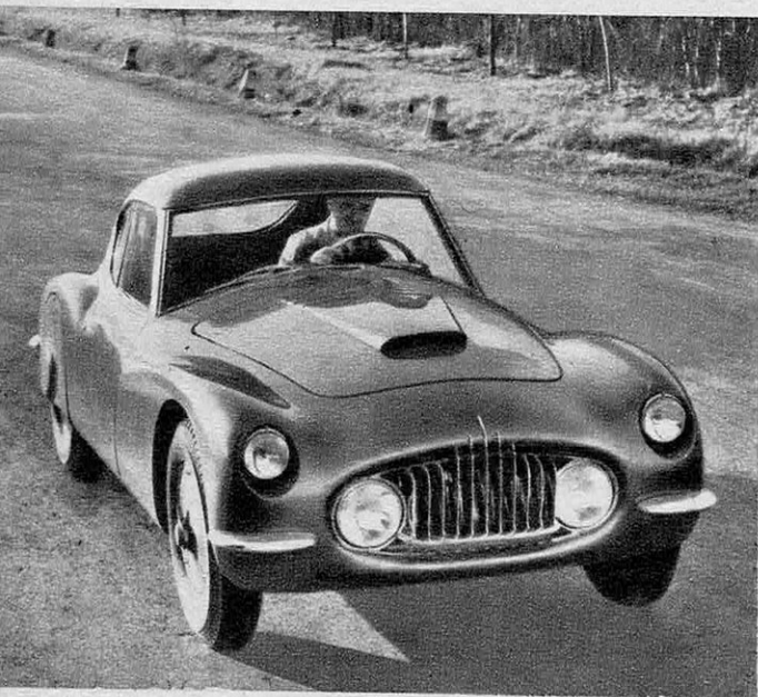
LA FIAT 8 V SPORT , coach très profilé et allégé, est équipée d'un nouveau moteur 2 000 cm 3 à 8 cylindres en V à 70°. Elle fit son apparition en compétition dans la Targa Florio 1952.
