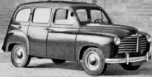
LA « PRAIRIE » RENAULT , voiture mixte 6-7 places, 800 kg, pouvant rouler sur tous chemins. La banquette arrière démontée, elle offre une capacité de 3,4 m 3 . On peut aussi lui atteler une remorque de 1 000 kg.
