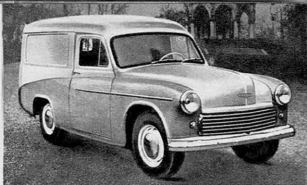
LA COMMER « EXPRESS DELIVERY » , véhicule utilitaire anglais avec châssis « tourisme », est équipée d'un moteur 4 cylindres de 1 265 cm 3 . Charge utile 500 kg.
