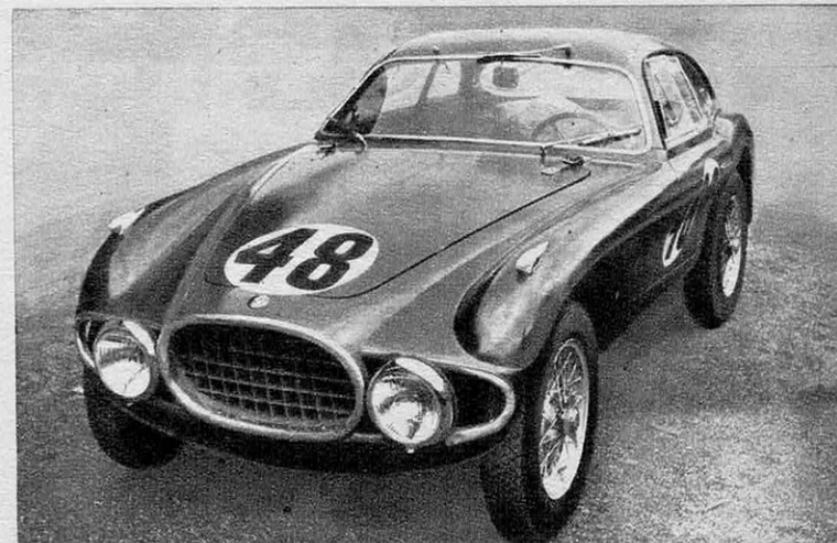
L'OSCA 1 350 cm 3 , construite par les frères Maserati, comporte un moteur 4 cylindres à double arbre à cames en tête, 90 ch. Avec son panneau latéral dégageant les roues, elle évoque la berlinette de Ferrari.
