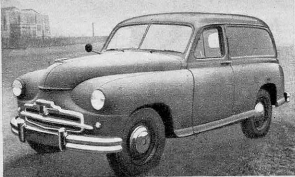
LA STANDARD « DELIVERY VAN » offre une capacité de 3 m 3 pouvant loger 600 kg de marchandises. Comme sur la berline, le moteur est un 2 088 cm 3 4 cyl.
