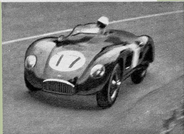
STIRLING MOSS SUR JAGUAR XK 120 C surprofilé mena à son tour à grande allure, mais, par suite du mauvais refroidissement du moteur, fut contraint à l'abandon, malgré la modification en dernière minute de l'entrée d'air.
