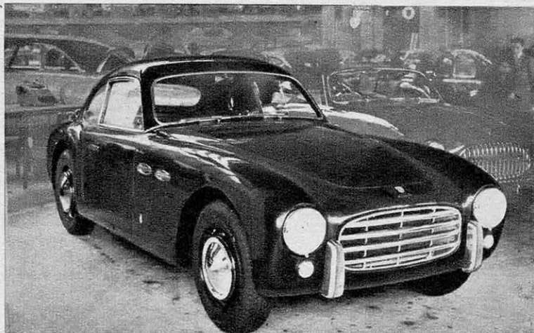
LA CISITALIA 2 800 cm 3 comporte un châssis léger équipé d'un moteur 4 cylindres, 2 800 cm 3 , licence BPM, capable de développer plus de 150 ch. L'ensemble boîte-pont arrière est emprunté à la Lancia « Aurelia ».
