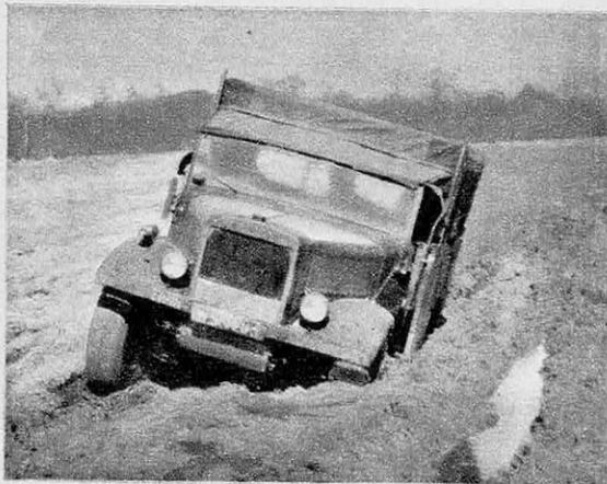
● Un prototype 1952 de camionnette Latil, à quatre roues motrices, spécialement étudié pour l'armée française, exécute ses essais sur piste particulièrement boueuse.
