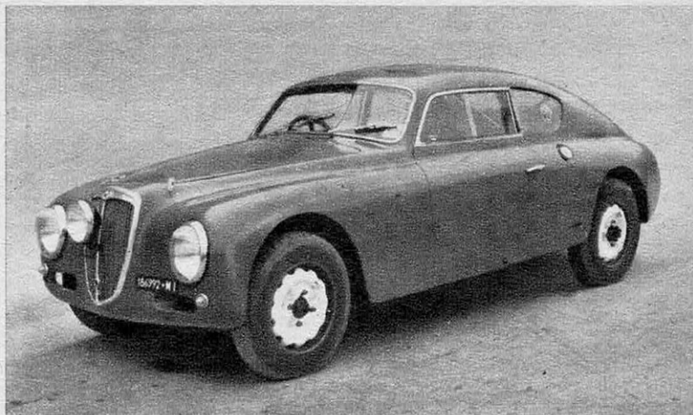
LA LANCIA « GRAN TURISMO » est la version surbaissée du coach profilé de série, munie d'un moteur 1 991 cm 3 , 6 cylindres en V, poussé à 105 ch. Elle s'est illustrée aux Mille Milles et aux 24 heures du Mans.
