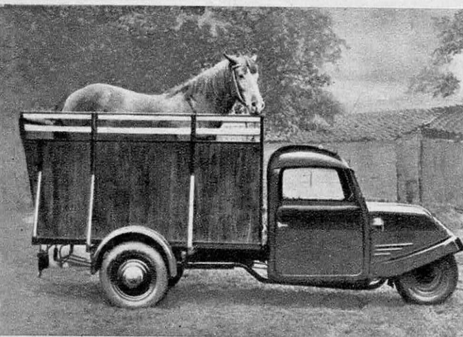
LA FOURGONNETTE GOLIATH A TROIS ROUES , de 750 kg. équipée d'un moteur 2 cylindres - 2 temps de 396 cm 3 , est construite avec 26 carrosseries différentes. Ci-contre le châssis rigide avec moteur à l'avant et roues arrière motrices; roue avant directrice avec suspension par bras-essieu.
