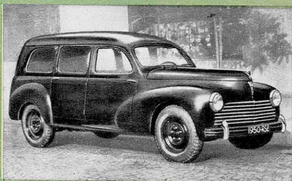
LA PEUGEOT 203 U , limousine commerciale, 4 places ou 450 kg de charge utile. La banquette arrière et un siège avant démontables permettent de transporter des objets de grande longueur.
