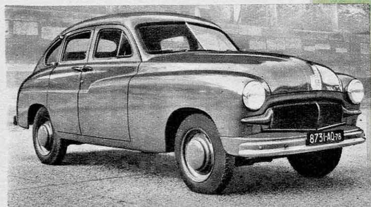
LA FORD « ABEILLE » à moteur V 8 est à la fois véhicule de tourisme : 5 places confortables, et véhicule utilitaire : 500 kg de charge utile et possibilité de tirer une remorque de même poids. Sur une version destinée au médecin rural, les sièges abattants forment couchette pour le transport d'un malade. Noter la facilité d'accès : portes s'ouvrant à 90°, pied de caisse intermédiaire démontable instantanément sur une simple pression.
