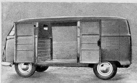
LA CAMIONNETTE VOLKSWAGEN de 750 kg. dérivée de la célèbre voiture allemande. Elle utilise le même moteur de 1 131 cm 3 de cylindrée (4 cylindres opposés horizontaux, refroidis par air). Elle comporte à la partie centrale un vaste espace accessible par deux portes latérales, disposition qu'impose le moteur placé à l'arrière.
