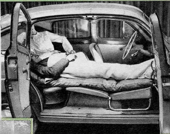
LA FORD « ABEILLE » à moteur V 8 est à la fois véhicule de tourisme : 5 places confortables, et véhicule utilitaire : 500 kg de charge utile et possibilité de tirer une remorque de même poids. Sur une version destinée au médecin rural, les sièges abattants forment couchette pour le transport d'un malade. Noter la facilité d'accès : portes s'ouvrant à 90°, pied de caisse intermédiaire démontable instantanément sur une simple pression.
