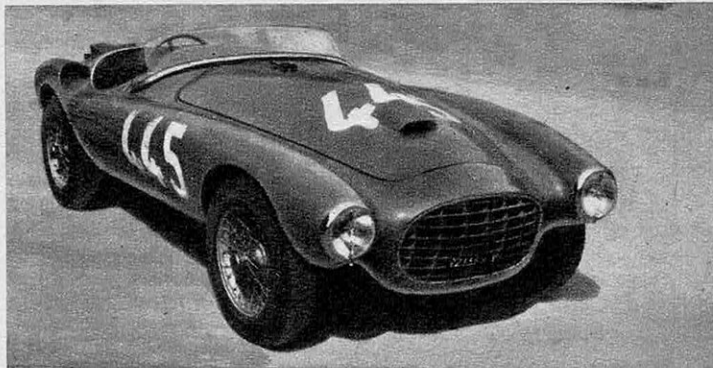
UNE FERRARI 4 100 cm 3 12 cylindres, type Tour de Sicile, avec le nouvel habillage allégé : on remarquera le curieux évidement de la fausse aile arrière pour le refroidissement des freins.
