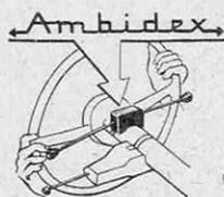
A portée des doigts, il permet, d'une main ou de l'autre, la commande instinctive des indicateurs de direction et des avertisseurs sonores ou lumineux sans risque d'oubli ou de dérèglement. Plus de boîte clignotante ni de minuterie. Le plus simple, le plus sûr. Pose facile et rapide. Demandez notice S.
