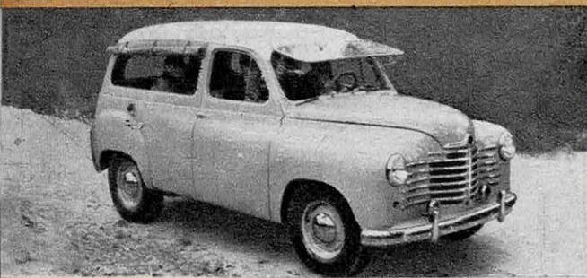
RENAULT « SAVANE », 1 TONNE. Autre exemple de véhicule colonial léger, ayant participé au rallye Méditerranée-Le Cap. Moteur à essence 4 cylindres, type 85, de 2,5 l de cylindrée.
