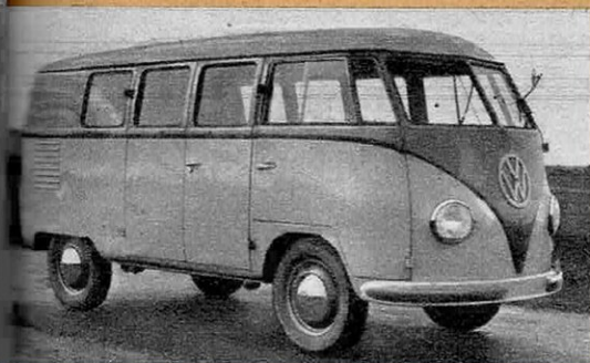
VOLKSWAGEN : Destiné à un service analogue à celui du petit car DKW, ce 10 places VW, élégant et robuste, comporte un mécanisme entièrement groupé à l'arrière.
