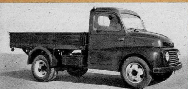
FIAT 615, 1,5 TONNE. Ce nouveau modèle italien est du type à cabine semi-avancée. Il est muni du même moteur 4 cyl. que celui développant 42 ch qui équipe la voiture de tourisme type 1 400.
