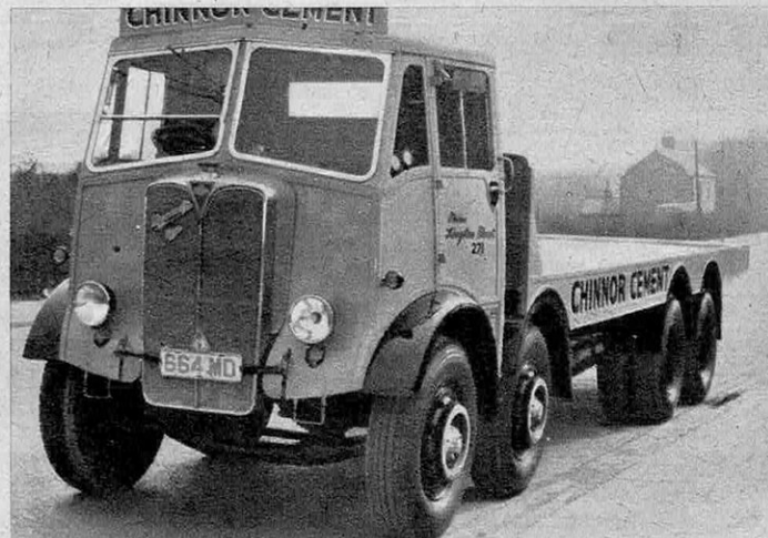
Le Mammouth Major «8» est un véhicule à 4 essieux dont la cabine et la caisse sont construites en alliage léger.
