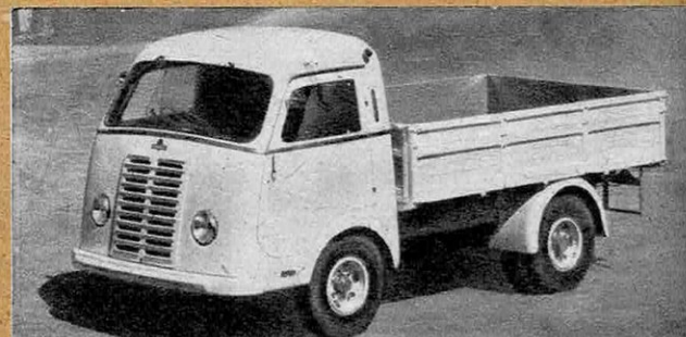
MASERATI « MULETTO », 1,5 TONNE. La structure de cet utilitaire léger est la réduction de celle d'un gros poids lourd. Il est muni d'un moteur 2 cylindres, 2 temps, soit de 425, soit de 500 cm 3 .
