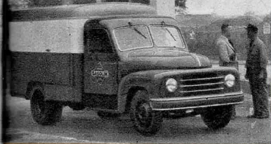
HANOMAG, CAMION 1,5 TONNE. Ce véhicule rapide est propulsé par un moteur diesel 4 cylindres de 2 800 cm 3 . L'habillage simplifié évoque celui du modèle « Pick-up » Delahaye.
