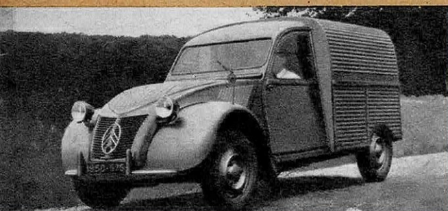
CITROEN 2 CV. La nouvelle camionnette à caisse tout acier à grand volume en tôle gaufrée, a de nombreux organes communs avec la berline, le moteur a une cylindrée de 425 cm 3 .
