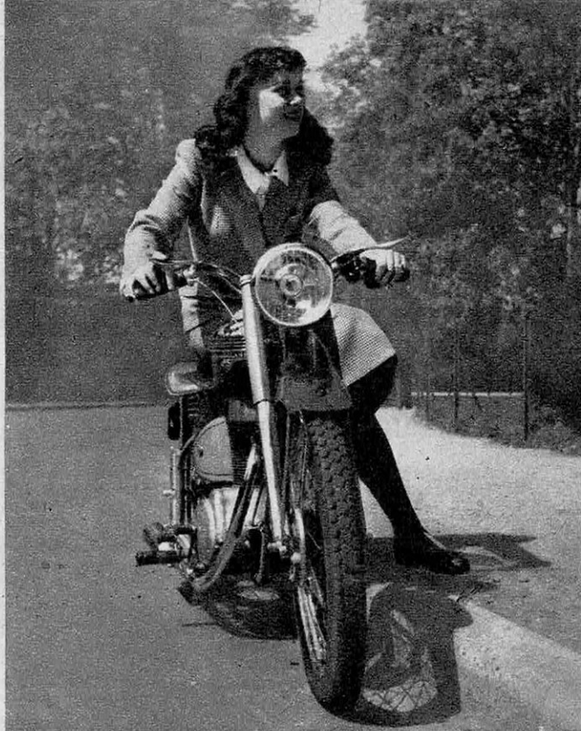
MOTOBÉCANE Z 2 C : Cette motocyclette légère est une 175 cm 3 de luxe, à moteur à 4 temps et à soupapes en tête ; elle possède une suspension avant et arrière à fourches télescopiques. Avec son équipement grand routier, elle atteint 95 km/h.
