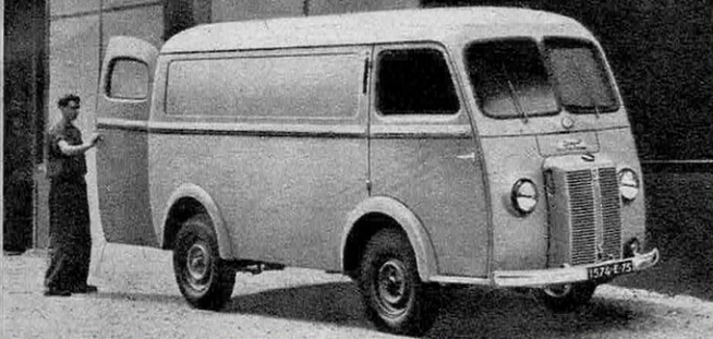
PEUGEOT D 3 A, 1,4 TONNE. Fourgon mono-coque entièrement métallique, équipé d'un moteur 203 de 1 290 cm 3 avec transmission aux roues avant. Le plancher est surbaissé et plat.
