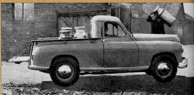
STANDARD « PICK-UP », 1 TONNE. Camionnette de ramassage dont la structure dérive directement de celle de la voiture « Vanguard » à moteur 2,088 litres, 68 ch. Ressorts arrière renforcés.
