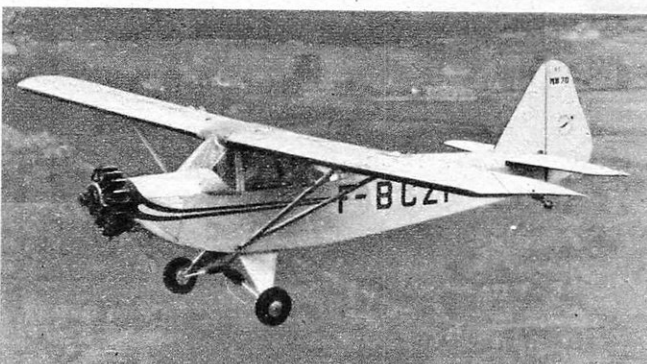
BROCHET M.B. 70 (France), monoplace construction amateur. Moteur Salmson 70 ch. Vitesse de croisière 145 km/h. Ne se met en perte de vitesse qu'à 25 km/h.
