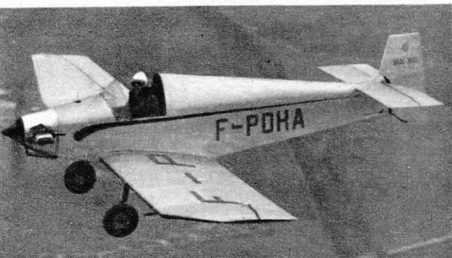
D. 9 « BÉBÉ-JODEL » (France), avion de sport monoplace en bois pouvant être réalisé par un constructeur amateur. Moteur Volkswagen 26 ch, vitesse 120 km/h.
