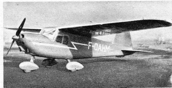
MACCHI MB 308 (Italie), biplace léger dont il existe une version à flotteurs et moteur de 90 ch, alors que l' version terrestre est équipée d'un Continental de 65 ch.
