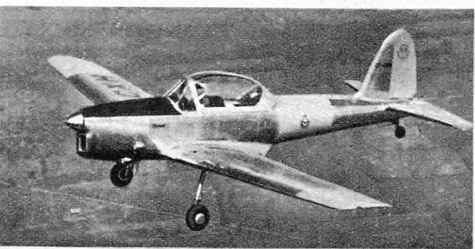
DE HAVILLAND « CHIPMUNK » (Can.) Ecole : deux postes de pilotage l'un derrière l'autre. Moteur de 140 ch, vitesse de croisière 200 km/h, autonomie 780 km.
