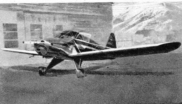
CALL-AIR MODEL A - 2 (U.S.A.), biplace côte-à-côte léger équipé d'un moteur Lycoming de 165 ch, vitesse de croisière 175 km/h, capable de décoller sur 130 m.
