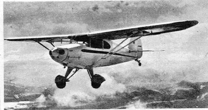
PIPER « PACER » (U.S.A.), quadriplace construit à plus de 550 exemplaires en 1950. Vitesse de croisière 215 km/h avec une hélice à pas variable (Model 135).
