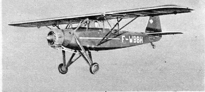
C.F.A. « PHRYGANET » (France), avion de tourisme biplace à aile haute haubannée, équipé d'un moteur Salmson de 90 ch. Vitesse de croisière: 140 km/h.
