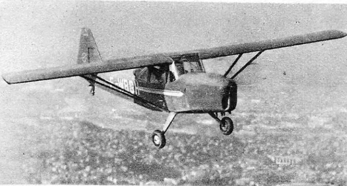
BROCHET M. B. 100 (France), avion de tourisme réalisé par un constructeur artisan. Sièges en tandem. Moteur Hirth de 90 ch ; vitesse de croisière : 140 km/h.
