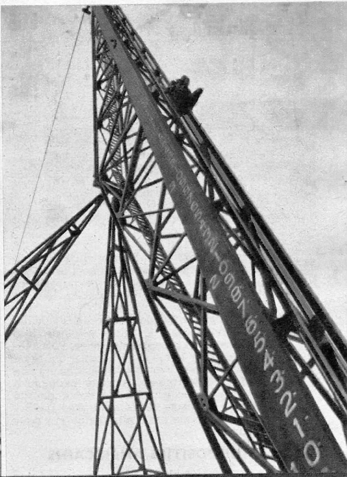
● Au bout de sa course, le siège est stoppé. Un treuil lui permet ensuite de redescendre lentement vers le sol.
