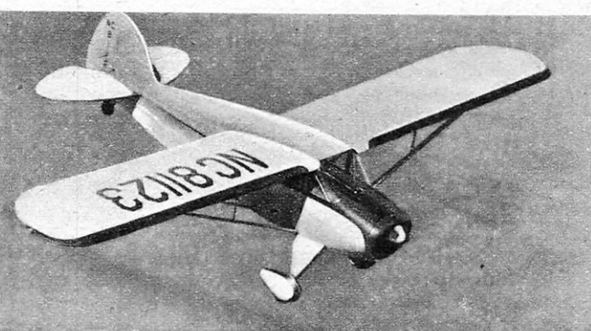
FUNK « CUSTOMAIRE » (U.S.A.), biplace côte-à-côte à moteur Continental de 85 ch, vitesse de croisière 160 km/h, rayon d'action 560 km, atterrissage à 60 km/h.
