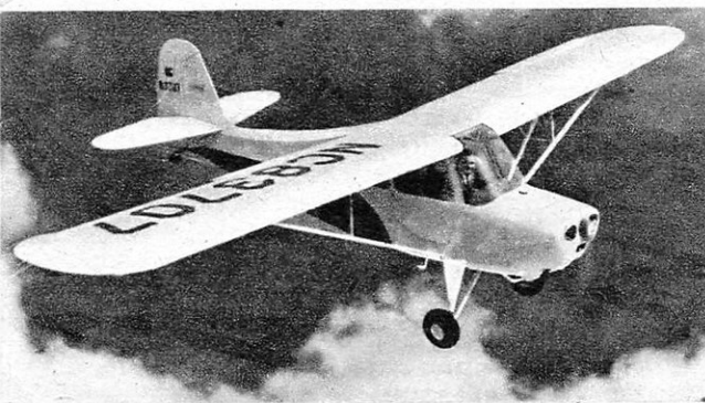
AERONCA « CHAMPION » (U.S.A.), biplace en tandem léger, construction métallique entoilée, vitesse d'atterr. 80 km/h, réservoirs auxiliaires dans les ailes.
