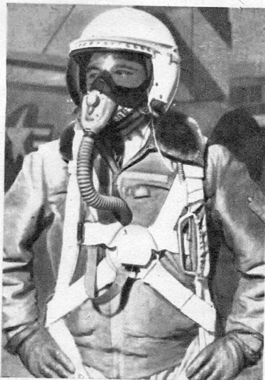
● Dans le dispositif américain d'éjection, une visière en plexiglas hermétiquement jointe au masque à oxygène et au casque du pilote, remplace le rideau qu'il déroule devant son visage dans le système Martin Baker.
