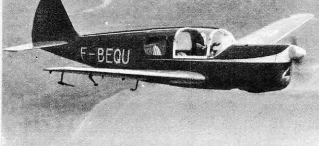
NORD 1203 « NORÉCRIN II » (S. N. C. A. N. France), avion de tourisme, dernière version du « Norécrin », aménagé pour 4 passagers. Il est fabriqué depuis 1948.
