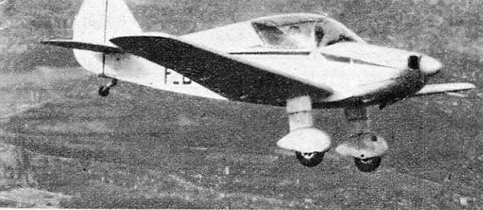
S.I.P.A. S. 901 (France), avion léger biplace à sièges côte-à-côte et poste de pilotage à deux commandes. Il est construit pour équiper les clubs aéronautiques.
