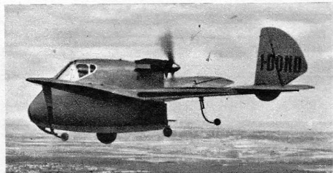
ALAPARMA « BALDO 65 » (Italie), biplace bipoutre léger qui peut être remorqué sur route par automobile une fois les deux poutres repliées le long du fuselage.
