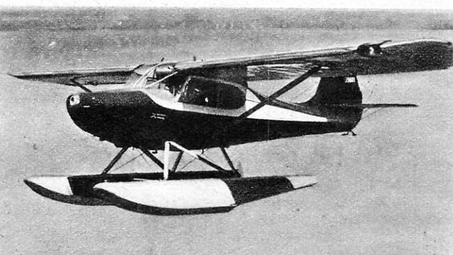
AERONCA « SEDAN » (U.S.A.), quadriplace dont on voit ici la version équipée de flotteurs. La visibilité vers l'avant est totale, la cabine est chauffée et insonorisée.
