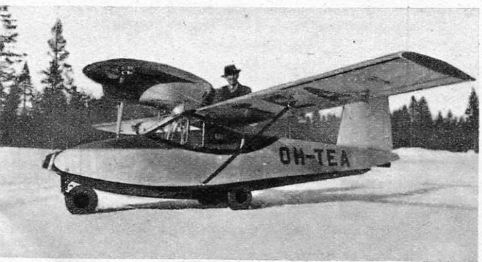
EKLUND TE - 1 (Finl.), monoplace amphibie à ailes pliantes, train tricycle. Vitesse 145 km/h avec moteur de 28 ch, sera équipé d'un moteur Continental de 40 ch.
