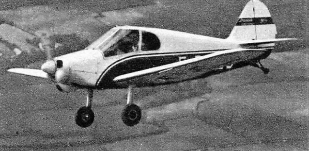
CAB « MINICAB » (France), avion de sport et de tourisme à deux sièges côte-à-côte. Un moteur Continental de 65 ch lui assure une vitesse de 180 km/h.
