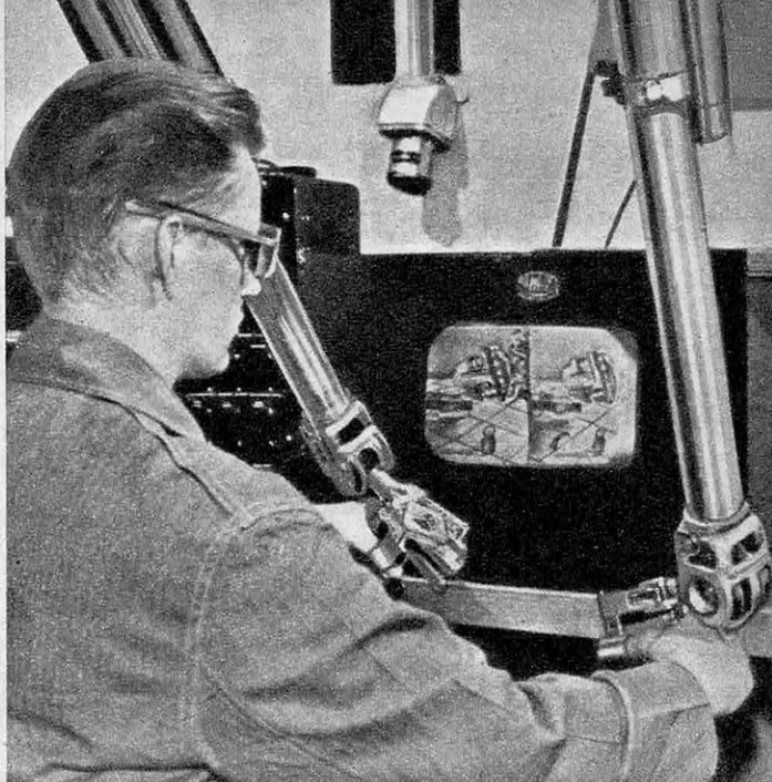
● L'opérateur muni de lunettes à verres polarisants observe les écrans qui donnent la sensation de relief.
