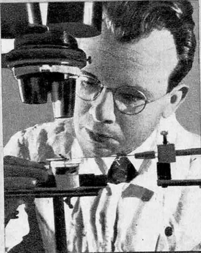
● Dosage d'une solution à l'aide d'une pipette capillaire qui permet de manipuler des microgouttes.
