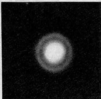
● L'onde associée aux électrons se diffracte comme la lumière. Voici deux diagrammes de diffraction électronique dans le celluloid et l'or.
