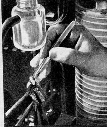
● Le microcreuset est placé dans un four électrique alimenté en courant de haute fréquence.
