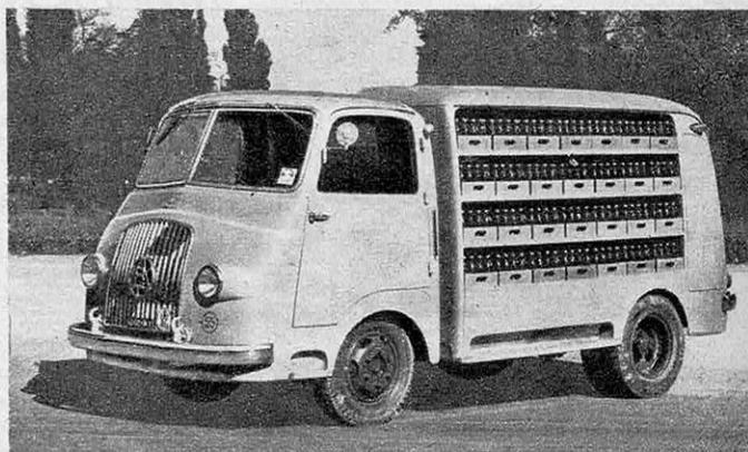
**BIANCHI**. Camion léger 2 t. sur chassis Sforzeco. Mot. 4 cyl., 44 ch, cadre tubulaire à treillis; roues AV indép.
