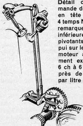
Détail de la commande des soupapes en tête du moteur 4 temps NSU-Fox : on remarque, à la partie inférieure, les taquets pivotants prenant appui sur les cames. Ce moteur a un rendement exceptionnel : 6 ch à 6 500 t/m, soit près de 61 chevaux par litre de cylindrée.
