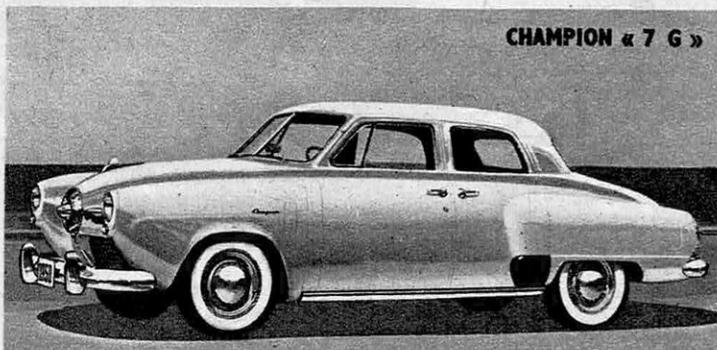
2,87 m; voie av. 1,43 m, arr. 1,37 m. Rayon de braq. 6,25 m. Long. h. t. 5,01 m., larg. h. t. 1,77 m., haut. 1,56 m, garde au sol 0,18 m. Poids de la berline 1 280 kg. **Vitesse max.** 135 km/h.
