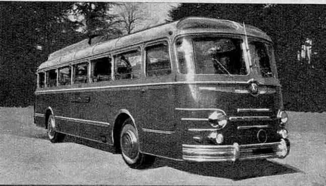
**ISOBLOC-BESSET** : Autocar type 149 DP, grand luxe, 38 places. Structure monocoque. Moteur Diesel.
