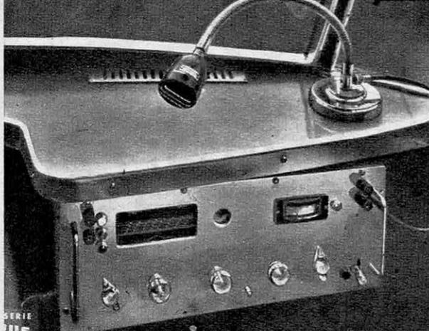
● Radio-récepteur amplificateur d'autocar type Voxcarlux : 12 lampes. Cet appareil permet la réception, les annonces intérieures au microphone et l'audition de disques (montage Delahaye-Currus).
