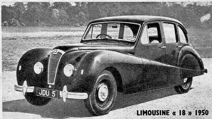
transv. et barres de torsion. Susp. arr. essieu rigide, ressorts semi-elliptiques. 4 amort. hydr. Luvax-Girling. Frein à pied méc. Girling, frein à main méc. Direction vis
