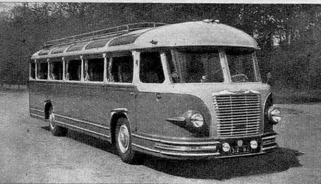
**CHAUSSON-DI ROSA** : Autocar de luxe, type « Atlantic ». Structure monocoque. Moteur Diesel.
