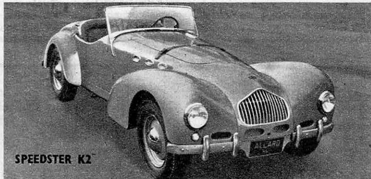
à sec. Boîte mécanique Ford, 3 vitesses, 2, 3 silencieuses et synchronisées, rapports 3,1/1, 1,76/1, 1/1, marche arr. 4,52/1; commande centrale. Arbre de transmission à joint de cardan Ford, pont hélicoï-
