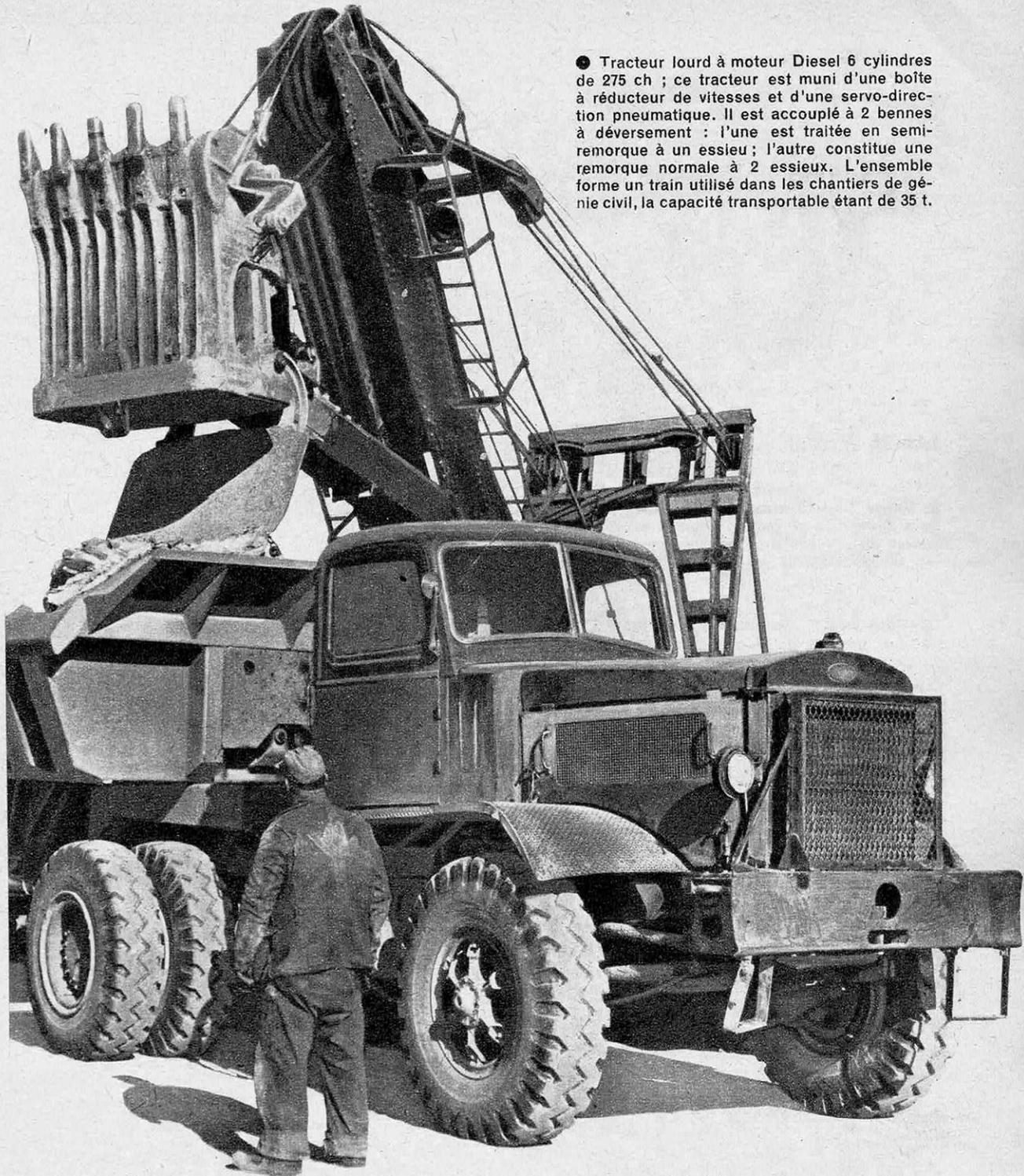
● Tracteur lourd à moteur Diesel 6 cylindres de 275 ch ; ce tracteur est muni d'une boîte à réducteur de vitesses et d'une servo-direction pneumatique. Il est accouplé à 2 bennes à déversement : l'une est traitée en semi-remorque à un essieu ; l'autre constitue une remorque normale à 2 essieux. L'ensemble forme un train utilisé dans les chantiers de génie civil, la capacité transportable étant de 35 t.
