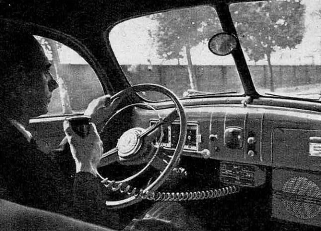
● Radio-récepteur « Philips » monté sur voiture Ford avec bloc spécial pour microphone : à gauche, le haut-parleur ; au centre du tableau de bord, commandes et inverseur pour conversation ou réception.
