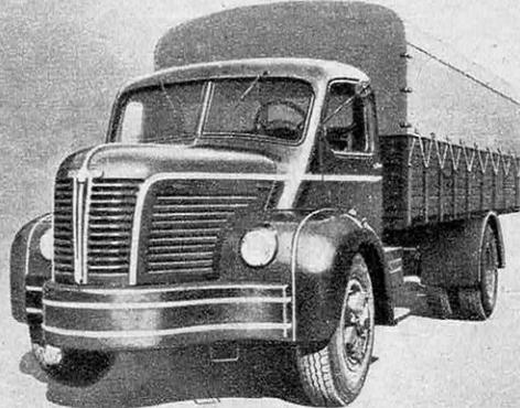
**RENAULT**, camion 5 et 7 tonnes. Moteur Diesel horizontal sous chassis, 6 cyl. 105 ch. Boîte à 5 vitesses.
