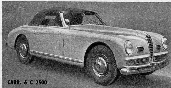
**COTES PRINCIPALES** : Emp. 3,00 m; voie av. 1,45 m, arr. 1,47 m. Rayon de braq. 5 m. Long. h. t. 4,90 m, larg. h. t. 1,82 m, haut. 1,57 m, garde au sol 0,17 m. Poids de la berline 1 500 kg. Poids du châssis nu 1 075 kg. **Vitesse max. 155 km/h.**
