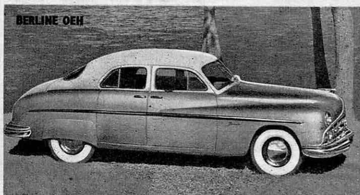
classique, à ressorts semi-ellipt. longit.; amort. télesc. Frein à pied hydr. duo-servo, frein à main méc. surr. arr. Direction Gemmer. Pneus 8,20 × 15. Réserv. 75 lit.
