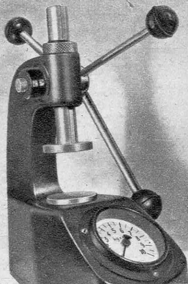
LA MACHINE MATAR mesure en une seule manœuvre les caractéristiques des ressorts de soupapes.
