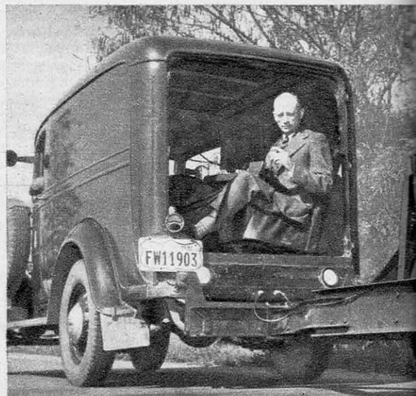
Machine à mesurer les rugosités de la route. Cet et l'amplitude des inégalités de surface, mesurant
