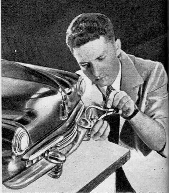
MISE AU POINT. — Tous les détails sont ensuite portés sur cette maquette et, dans une ultime mise au point, on vérifie l'exactitude de la reproduction.
