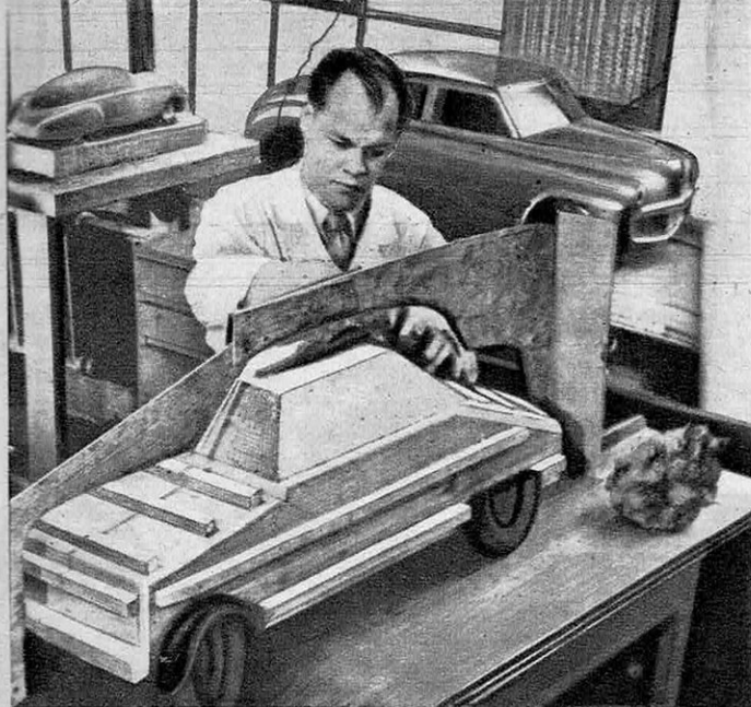
NAISSANCE DE LA FORME. — Longuement méditée, puis dessinée sur les indications des spécialistes, la maquette prend naissance entre les mains du modelleur.
