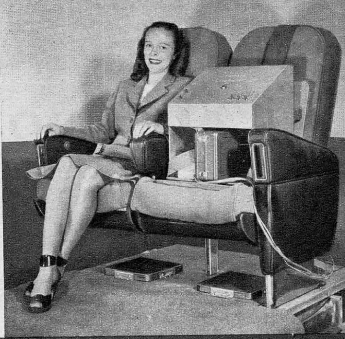
La fixation du siège est étudiée pour transmettre le minimum de vibrations qu'enregistre le « Ridometer ».
