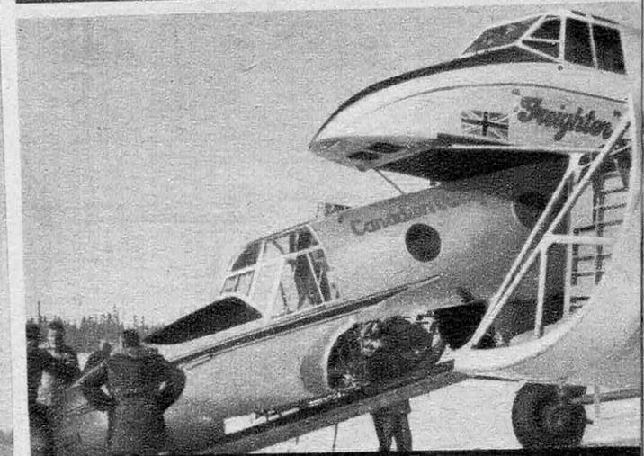
VERSION "FREIGHTER" DU "BRISTOL 170" : SOUTE DE 9 MÈTRES 50 DE LONG ET 57 M
