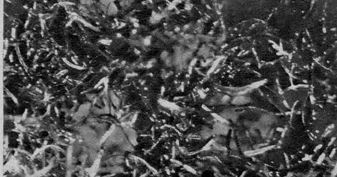
Filter à air Técalémit en tissu flocké Fibrac. Photographies grossies 58 fois montrant des grains de poussière retenus à la surface externe (à gauche) et interne (à droite) par les déchets de laine adhérent à l'armature.
