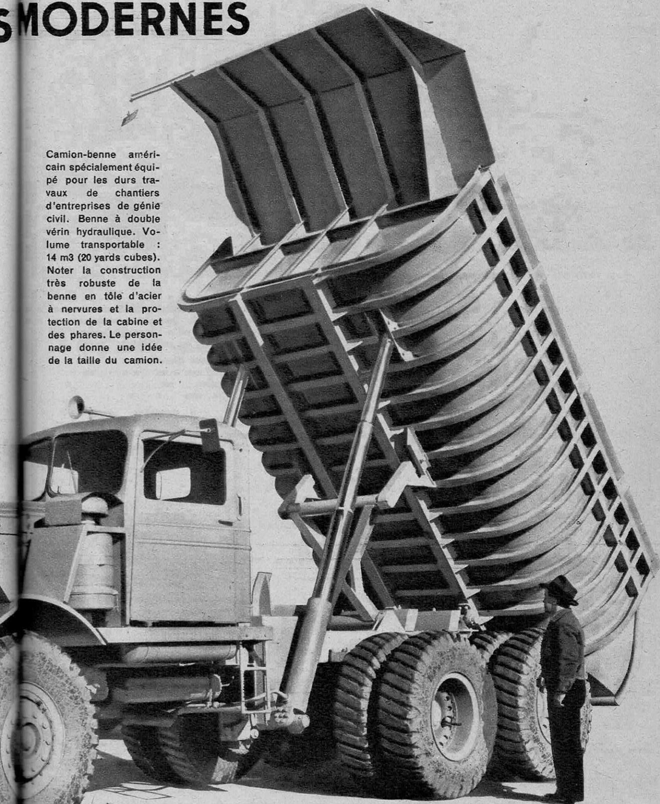
**KENWORTH—TYPE 888. MOTEUR DIESEL CUMMINS HB 600, 6 CYL., 150 CH.**
