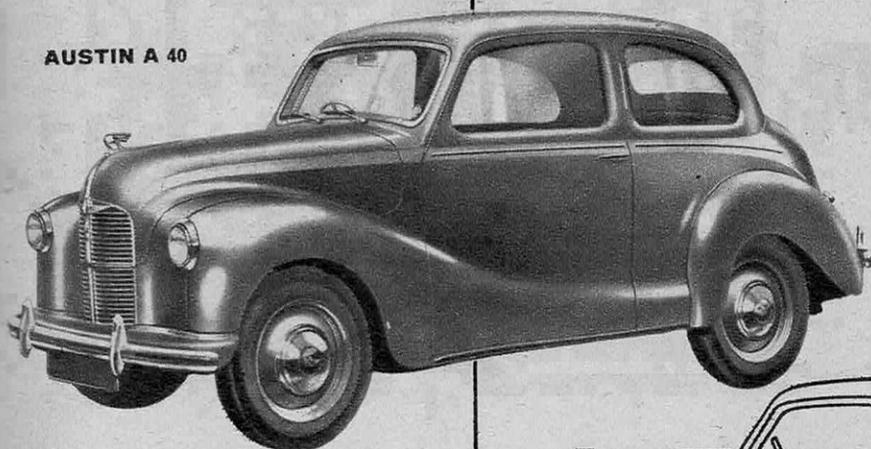
Moteur 4-cylindres à soupapes en tête, 1 200 cm<sup>3</sup>, 40 ch à 4 300 t/mn; moteur avant et roues arrière motrices; poids: 945 kg; vitesse: 105 km/h. Carrosserie entièrement métallique traitée soit en coach 4 places, 2 portes (Dorset), soit en limousine à 4 places, et 4 portes (Devon).
