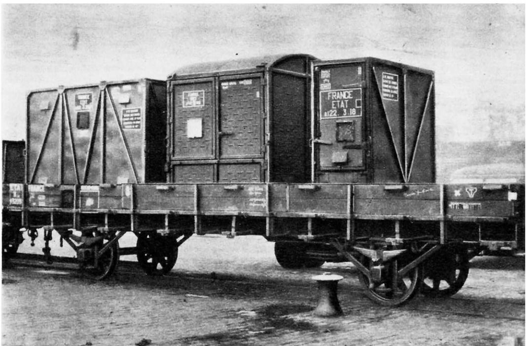
Fig. 110. TROIS MODÈLES DE GRANDS CADRES S. N. C. F. POUR LE TRANSPORT PORTE A PORTE
