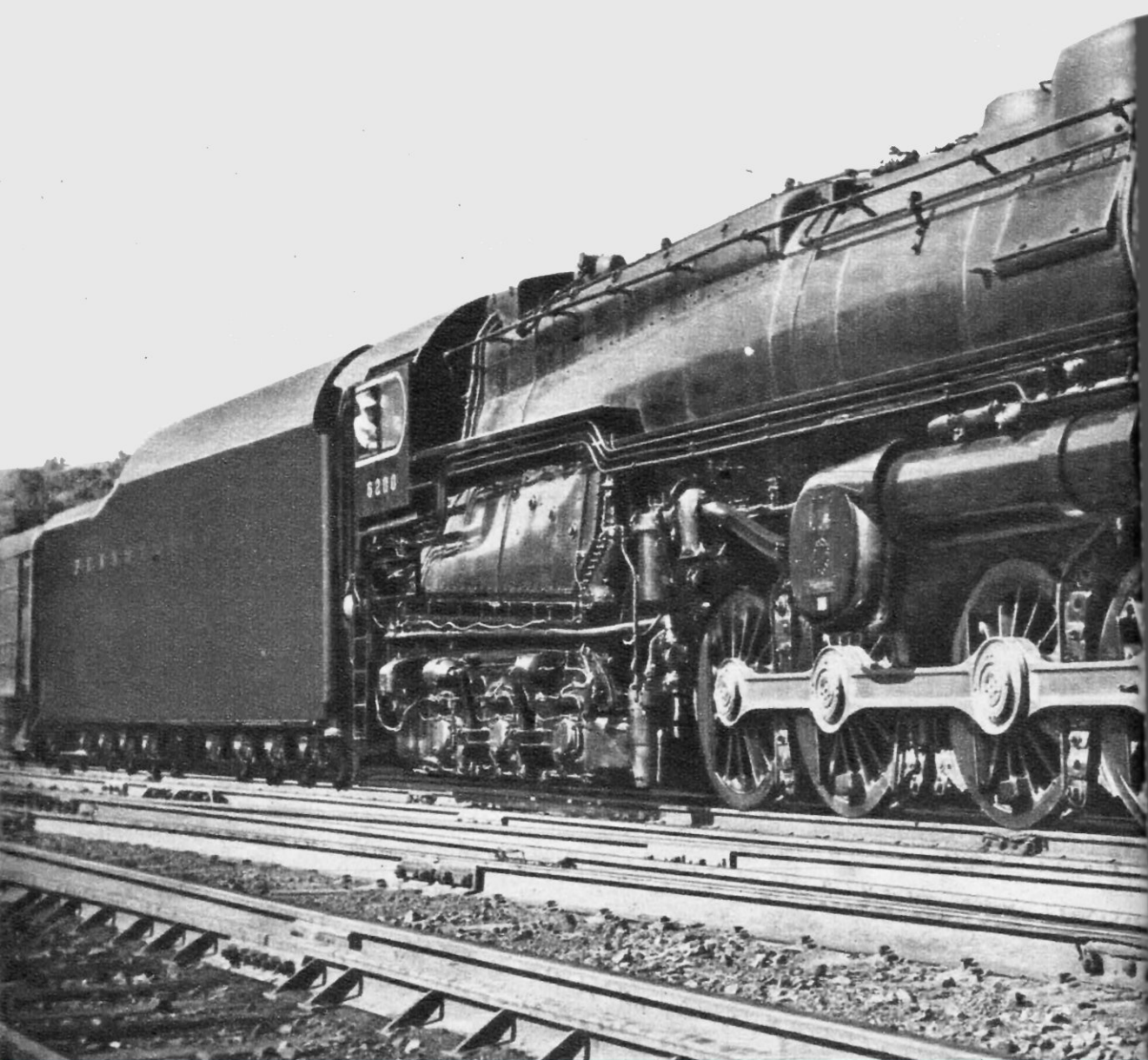
Fig. 43. — Cette locomotive, construite par Baldwin et Westinghouse pour le Pennsylvania Railroad, est chauffée au charbon et comporte : sur le côté droit, une turbine principale pour la marche avant, d'une puissance nominale de 6 900 ch, tournant à 9 000 t/mn ; sur le côté gauche, une turbine plus petite pour la marche arrière, d'une puissance nominale de 1 500 ch, tournant à 8 300 t/mn. Elle pèse au total, avec son tender, 417 t (290 t pour la machine seule). Elle développe, en marche avant, un effort de traction de 32 t et en
