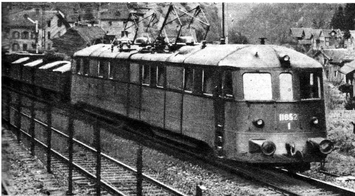
Fig. 62. LOCOMOTIVE ÉLECTRIQUE SUISSE DOUBLE (I BBI, I BBI), la plus puissante du monde Puissance : 11 400 ch ; longueur : 34 m ; poids en service : 236 t ; vitesse maximum : 110 km/h (CERlikon).
