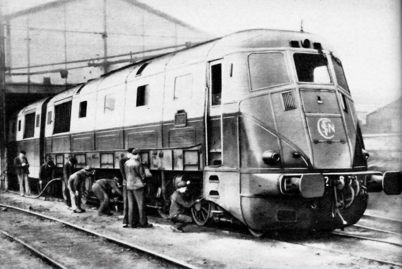
Fig. 75. RAVITAILLEMENT ET VISITE D'UNE LOCOMOTIVE DIESEL-ÉLECTRIQUE FRANÇAISE DE 4 000 CH
