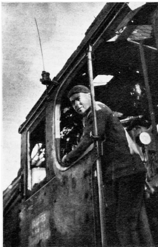
Fig. 119. L'ANTENNE DU RÉCEPTEUR installée sur le toit de la cabine de la locomotive
