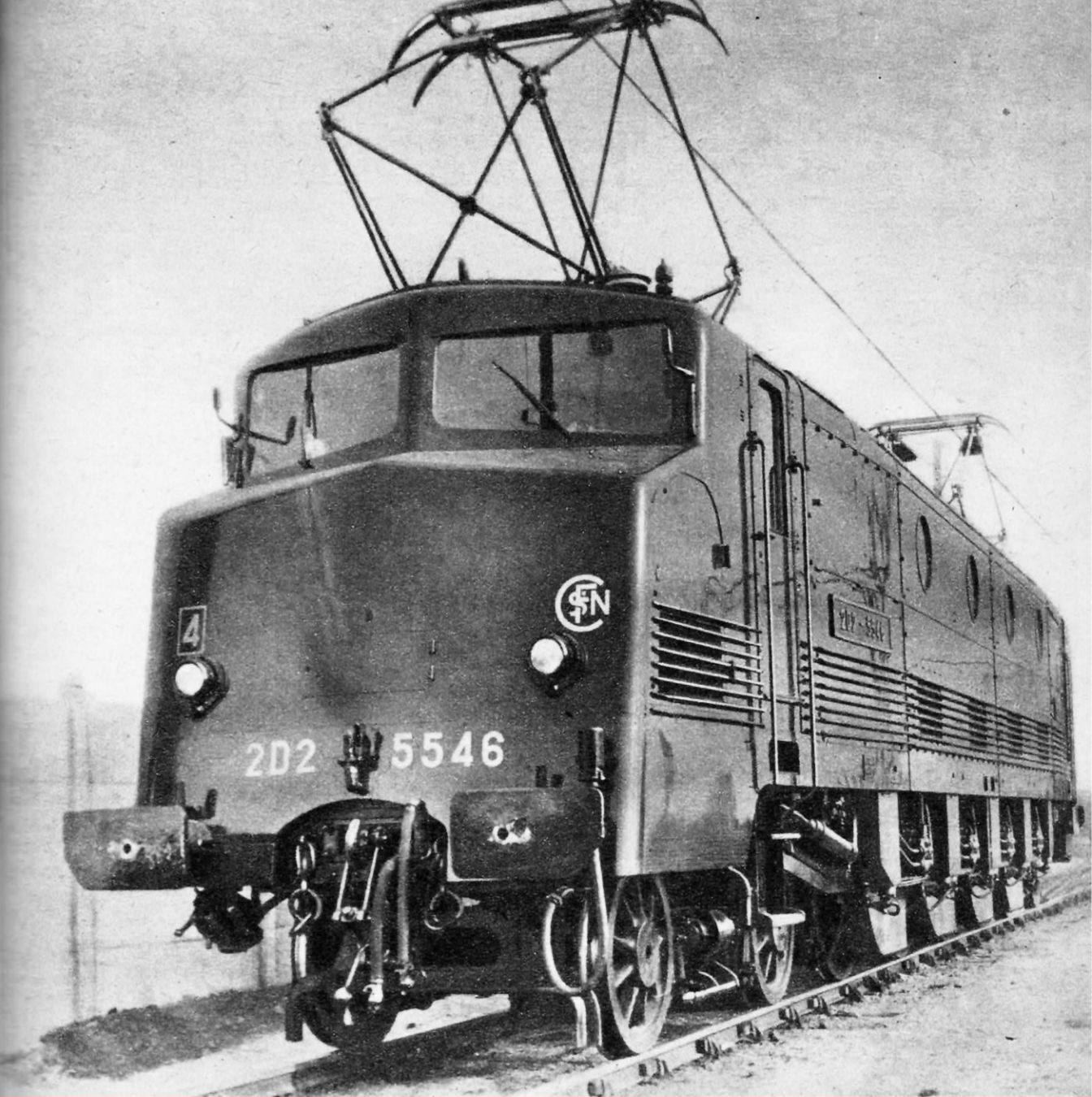
Fig. 66. LA LOCOMOTIVE ÉLECTRIQUE TYPE 2D2 POUR TRAINS EXPRESS ET RAPIDES
