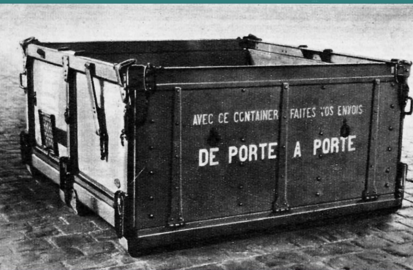
Fig. 109. GRAND CADRE OUVERT REPLIABLE POUR LE TRANSPORT DES MATÉRIAUX DE CONSTRUCTION : TUILES BRIQUES, ETC.
