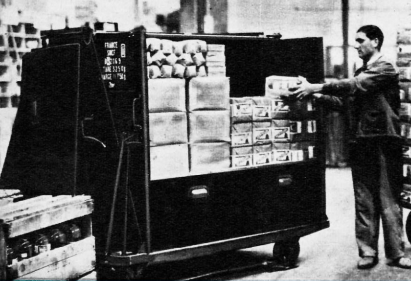
Fig. 107. PLACEMENT DES MARCHANDISES DANS UN PETIT CADRE GRACE AUX TROIS PANNEAUX LATÉRAUX DÉMONTABLES
