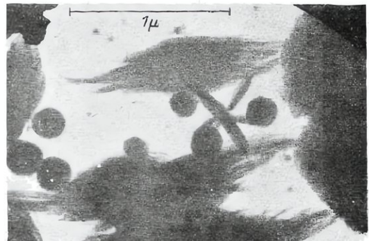
FIG. 73. — LES PRODUITS DE LA RÉACTION DU SILICATE TRICALCIQUE ET DE L'EAU (PRISE DU CIMENT) GROSSI 31 000 FOIS AU MICROSCOPE ÉLECTRONIQUE
