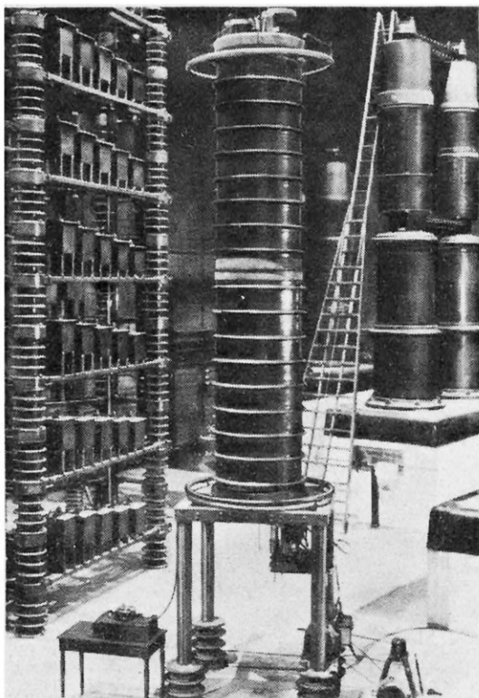
FIG. 9. — TUBE PRODUCTEUR DE RAYONS X DE TRÈS GRANDE ÉNERGIE (3 MILLIONS DE VOLTS) AU LABORATOIRE AMPÈRE (CENTRE NATIONAL DE LA RECHERCHE SCIENTIFIQUE ; DIRECTEUR : M. JOLIOT)
