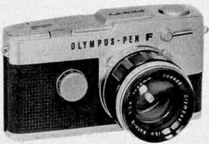
L'Olympus Pen FT (18 x 24) comporte une cellule CdS dans la visée reflex. Une disposition nouvelle du prisme et du miroir (voir schéma) a permis d'éliminer la forme en toit du boîtier.
