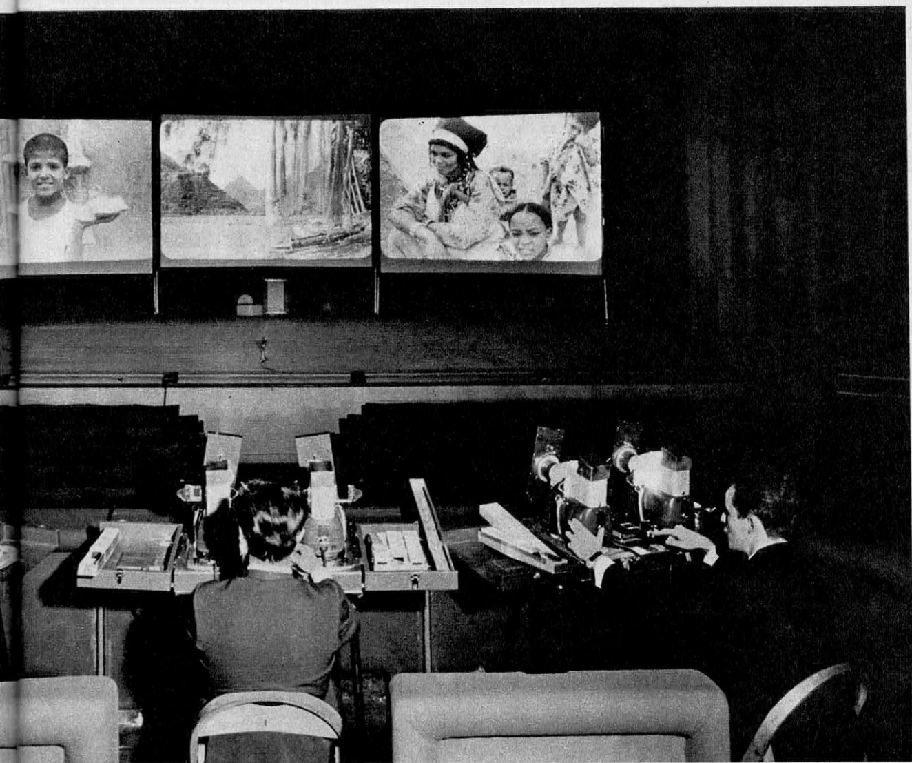
sur trois écrans au moyen de six projecteurs synchronisés avec un enregistrement sonore stéréophonique.
