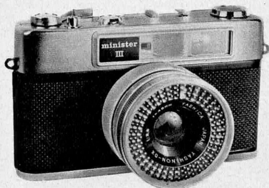
Modèle modeste, le Yashica Minister III comporte un objectif 2,8/45 mm, un obturateur Citizen de 1 s au 1/500 et pose, une cellule annulaire, un retardateur et un viseur à cadres lumineux.
