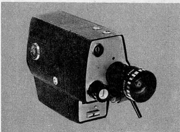
L'Autoreflex 9,5 vient de faire son apparition sur le marché. C'est une caméra automatique extrêmement robuste, à visée et cellule CdS reflex. Cet appareil reçoit le film 9,5 en chargeurs magazine de 15 m. Le moteur est électrique et entraîne la pellicule à des vitesses de 12, 16, 24 im/s et vue par vue. Zoom SOM Berthiot 17-85 mm.
