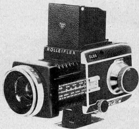
Reflex mono-objectif à optiques interchangeables, le Rolleiflex SL 66 comporte un soufflet à long tirage (photo rapprochée) basculable verticalement (afin de redresser les lignes fuyantes).
