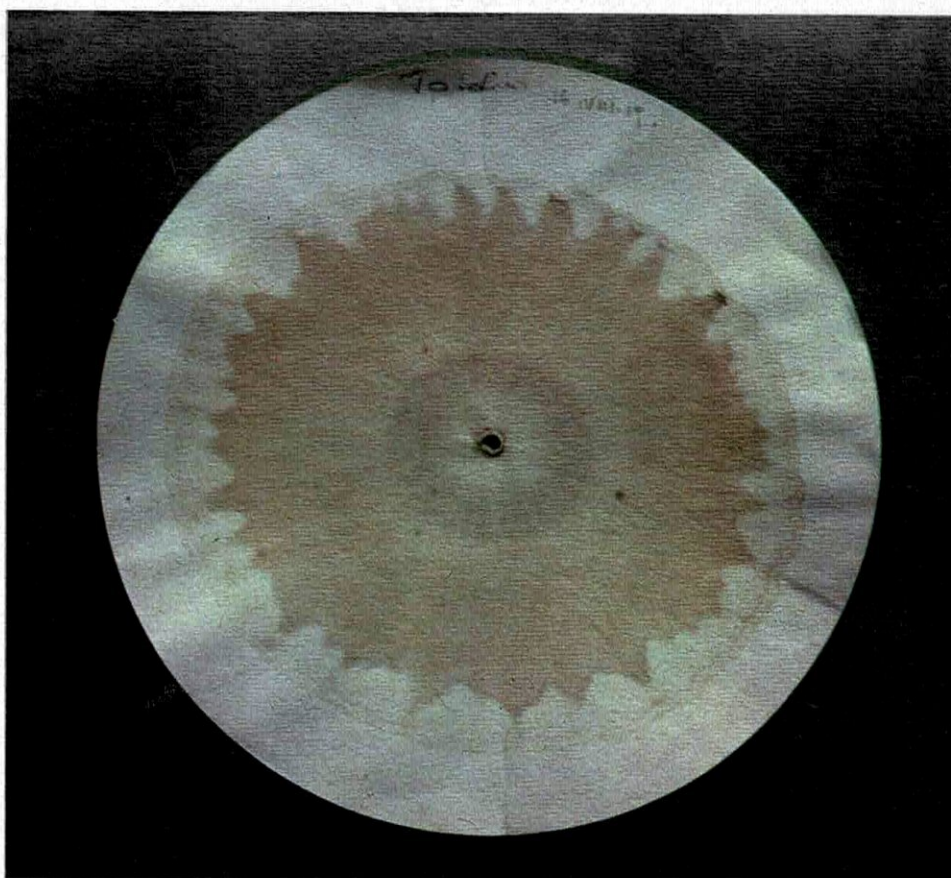
Chromatogramme d'une terre fertile et peu minéralisée. Les rayonnements sont plus souples. Tandis qu'apparaît un second cercle, signe de la richesse en humus. Ci-dessous, mode d'emploi pour réaliser le test (voir texte).
