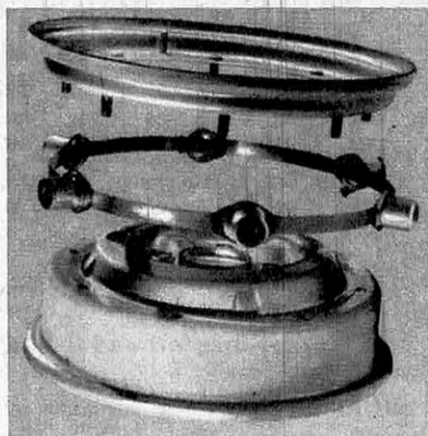
La roue est en deux parties et comporte des petits réservoirs qui libèrent un lubrifiant au moment de la mise à plat.
