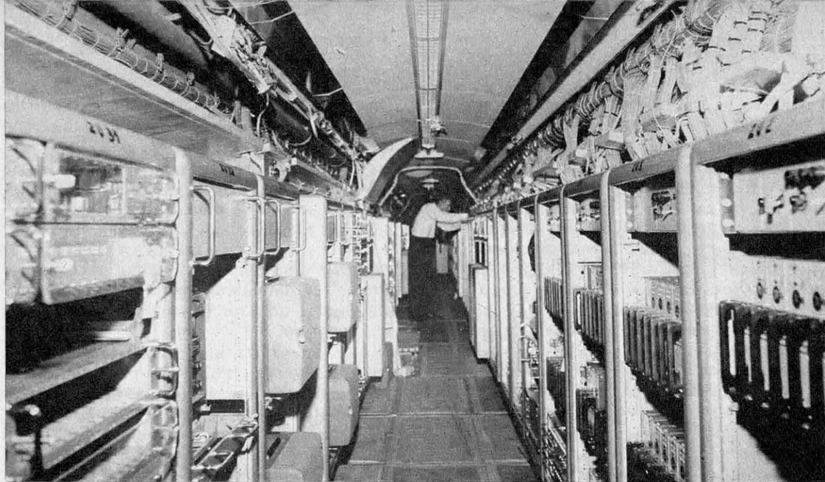
... Et 12 t, c'est le poids total des 350 équipements d'essai montés sur l'appareil.
