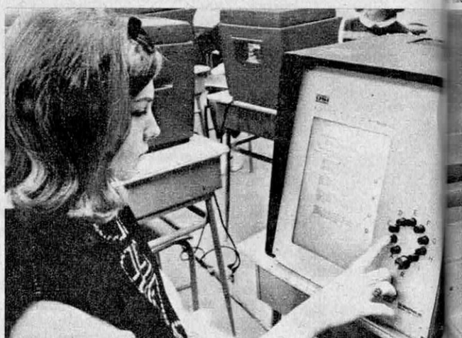
Un exemple d'enseignement programmé sur « Autotutor ». Les questions sont posées par la machine en fonction des réponses.
