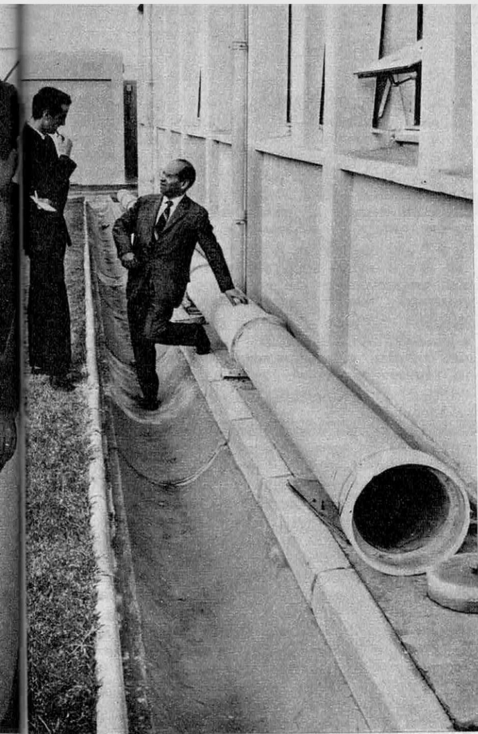
Sous l'apparence d'un banal tuyau d'égout se cache en réalité un tuyau d'orgue infra-sonore rigoureusement calculé. Longueur : 24 m.
