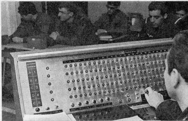
Le pupitre récapitulatif de la machine Betty III, à Rochefort. Chaque lampe-témoin représente une réponse possible des élèves.
