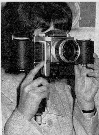
Sur le Topcon, l'entraînement de la pellicule est assuré par un moteur. Ce dernier est associé à un chargeur de 250 vues. Objectif Topcor f: 1,4.
