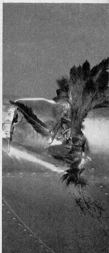
Le bord d'attaque de l'aile, minutieusement dessiné par les ingénieurs de l'aéronautique, se déforme complètement sous l'impact des volatiles. A Edimbourg, un quadrimoteur fut contraint à un atterrissage d'urgence : les ailes n'avaient plus de portance. Mais on devait retrouver sur le terrain les cadavres de 120 oiseaux.
