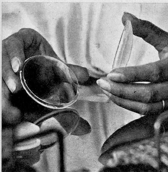
Démoulage de la lentille finie
