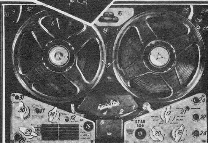
Cette photographie représente la platine du STAR 106 Le STAR 104 est identique, moins les organes concernant la Radio (29, 30, 31, 32)
