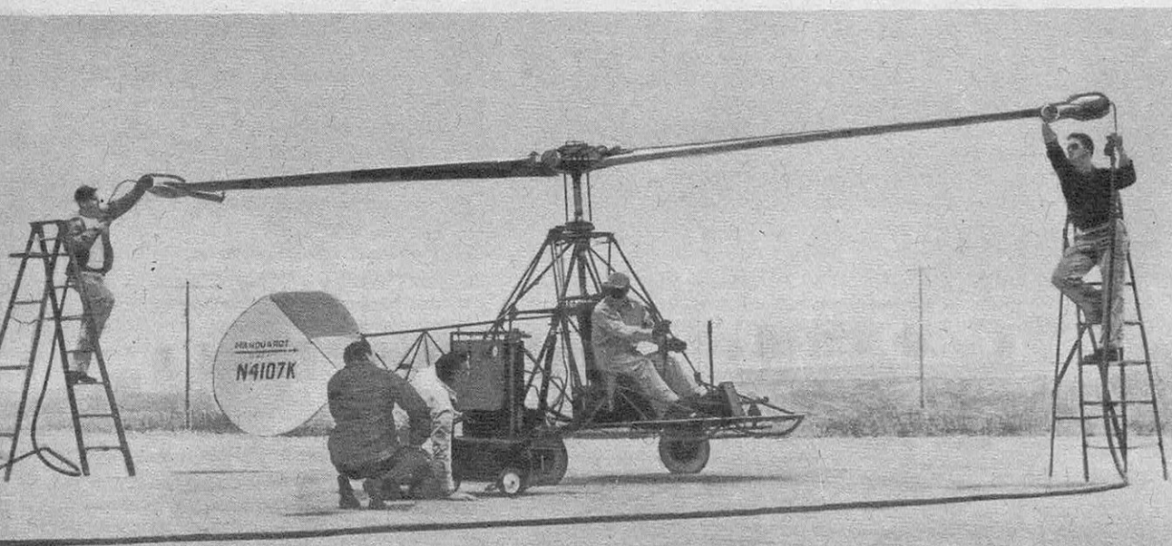
LE DÉMARRAGE A L'AIR COMPRIMÉ DES PULSORÉACTEURS D'UN HÉLIPTÈRE MARQUARDT
