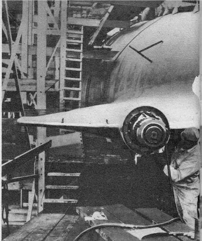
● Les hélices dont on voit l'un des axes, lui permettront, en plongée, une vitesse de 20 nœuds.
