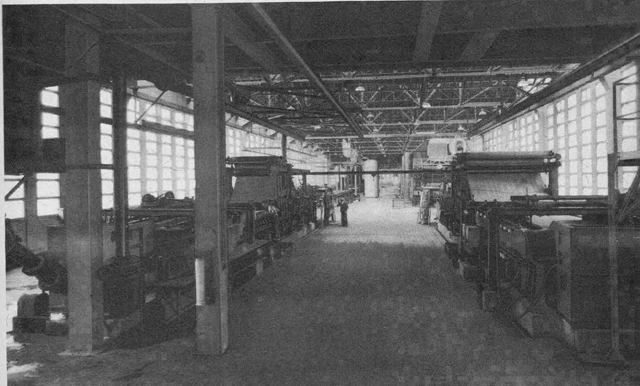
● A la sortie des mêmes appareils « défilators », l'usine Isorel, en France, dispose de deux immenses chaînes automatiques fabriquant, à g. des panneaux en reconstitué de différentes duretés, à dr. des plaques isolantes.
