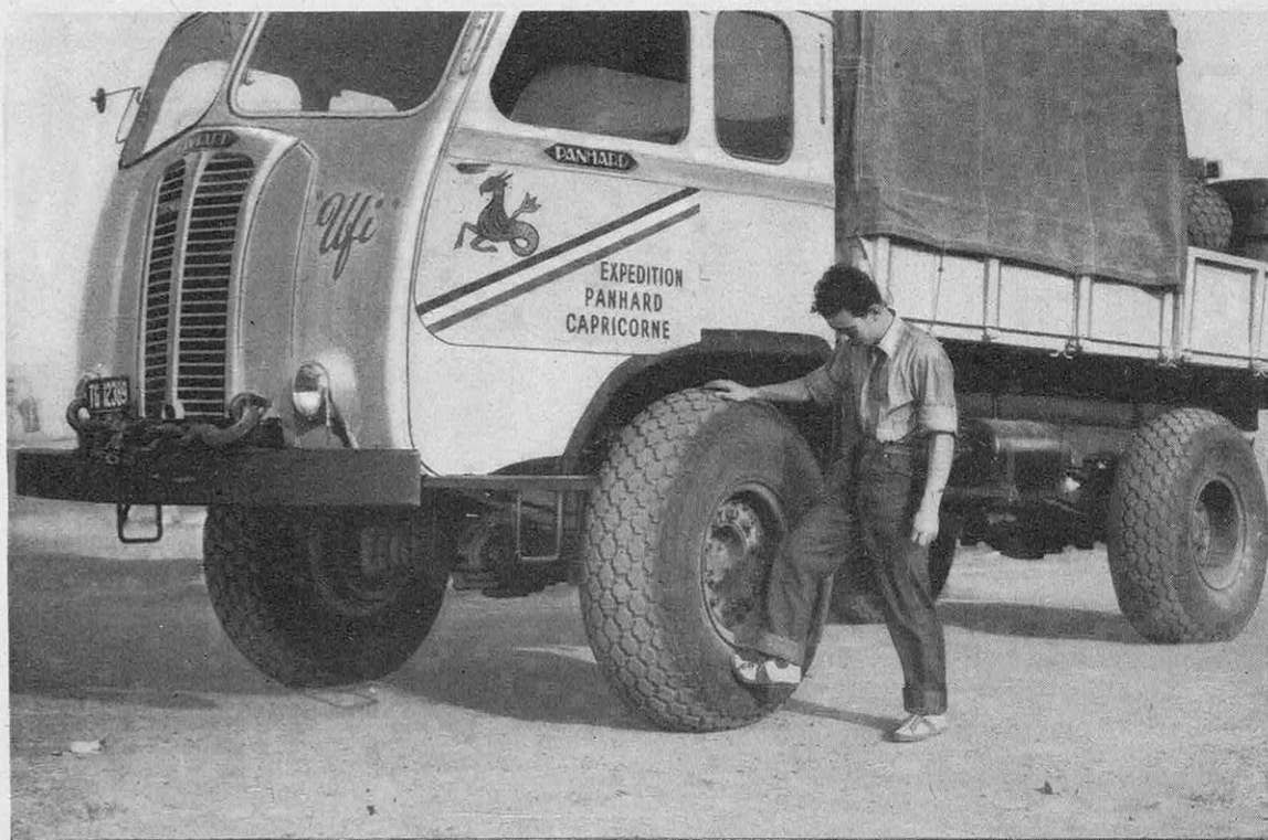
CES PNEUS, DESTINÉS A DES AVIONS DE 50 T, SUPPORTENT D'ÊTRE PEU GONFLÉS
