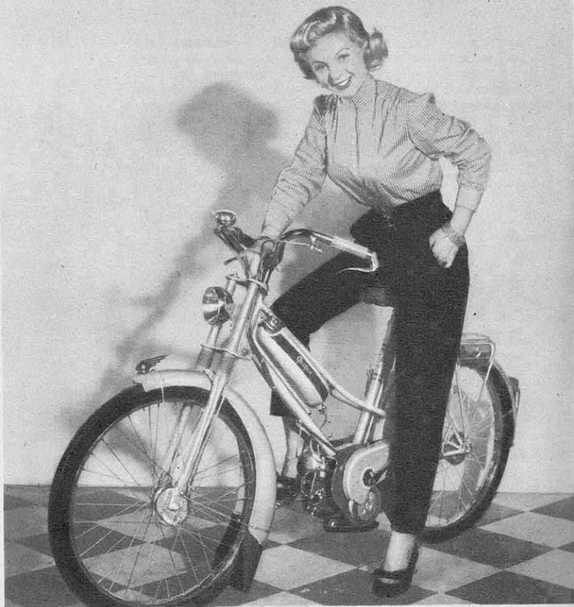
Vélocycle Peugeot type « Bîma » : bloc moteur de 48 cm 3 ; entraînement sur la roue arrière par galet avec dispositif à pression constante, réservoir de 2,5 l.
