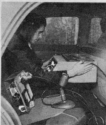
● Le bruit enregistré sur cette voiture française au moyen d'un magnétophone pourra être étudié à loisir au laboratoire.
