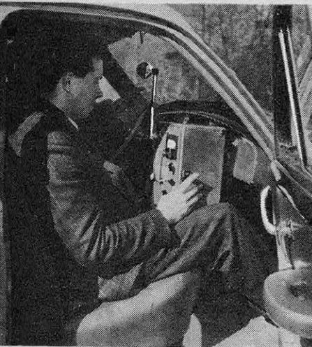
● Le sonomètre, muni d'un micro tenu près de l'oreille, permet de mesurer le niveau sonore global.
