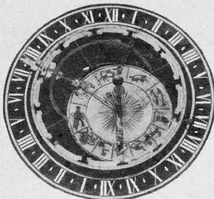
● A gauche : l'horloge astronomique-astrolabe de Prague ; à droite : celle de Berne, et ci-dessous : le cadran-astrolabe proprement dit. On remarque sur les appareils l'anneau excentrique qui représente la trajectoire apparente du Soleil autour de la Terre supposée fixe (écliptique).
