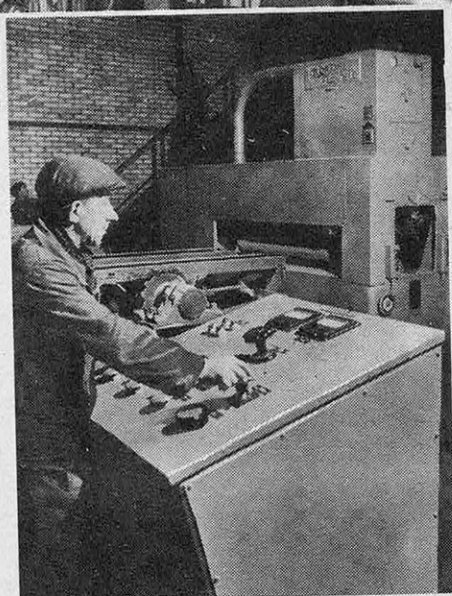
● De ce pupitre, en tournant un simple bouton, l'ouvrier commande la marche des laminoirs.
