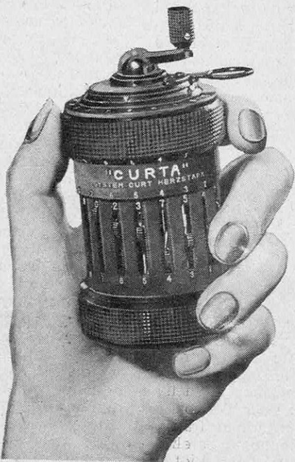
● Cette machine à calculer de poche, pesant 230 g, comporte deux compteurs et permet toutes les opérations (Curta).
