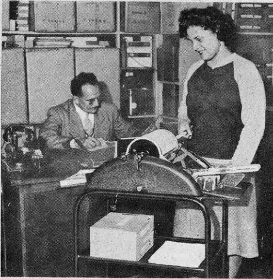
● Un duplicateur à deux usages : utilisant des stencils pour les gros tirages, cette machine s'adapte au procédé hectographique pour tirages restreints (Metro).
