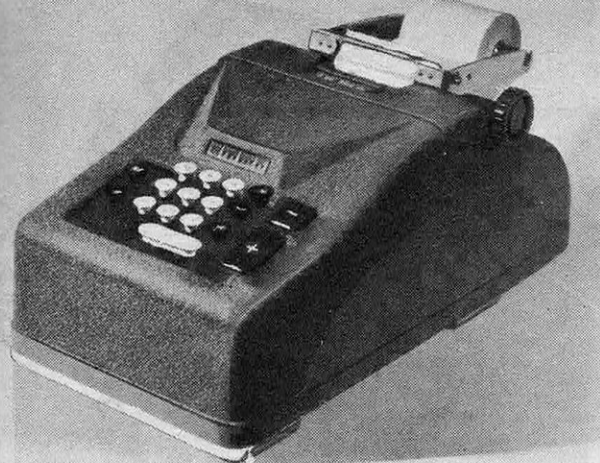
● Machine à additionner à clavier réduit (dix touches, plus les touches de 1, 2 et 3 zéros; fait aussi la soustraction et imprime sur bande opérations et résultats (Ultra).
