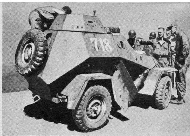
● Une « Jeep », automitrailleuse blindée à voie étroite spécialement conçue pour évoluer sur les levées de rizières.
