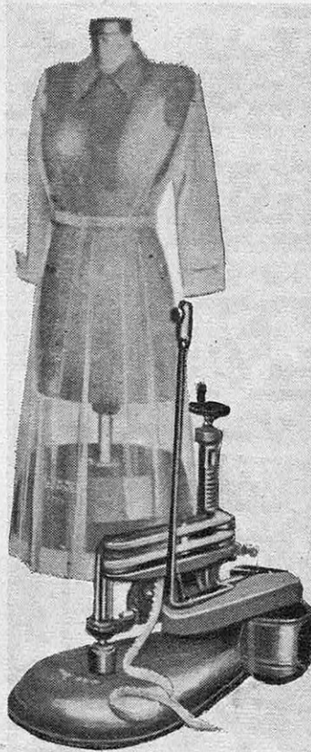
● Cette machine arrondit, découpe et dentelle électriquement le bas d'une robe en 1 mn. (Man-Sew).
