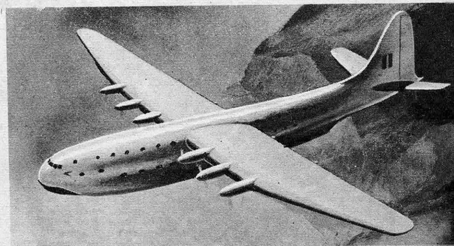
● L'hydravion long-courrier britannique Saunders-Roe « Princess » de 142 t a dix turbopropulseurs « Proteus » qui lui permettent de voler à plus de 600 km/h.
