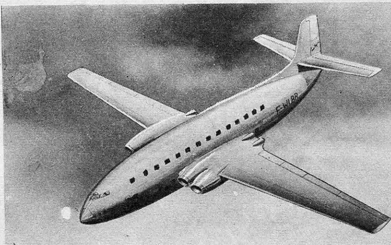
● Le Breguet « Fulgur » 97 (49t, 100 passagers) est équipé soit de quatre turboréacteurs « Nene », soit de quatre turbopropulseurs Armstrong-Siddeley ou Allison.
