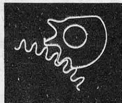
Cliquet à grand recul : évite la fatigue du ressort de barillet et permet une force motrice plus uniforme.
