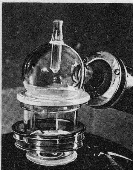
Distillation de l'eau et de l'alcool servant à diluer les substances solubles.
