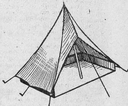
L'itisa française la perfectionne en ajoutant des murs et un double toit.
