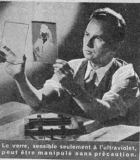
Le négatif photographique et la plaque photosensible sont placés dans un châssis.
