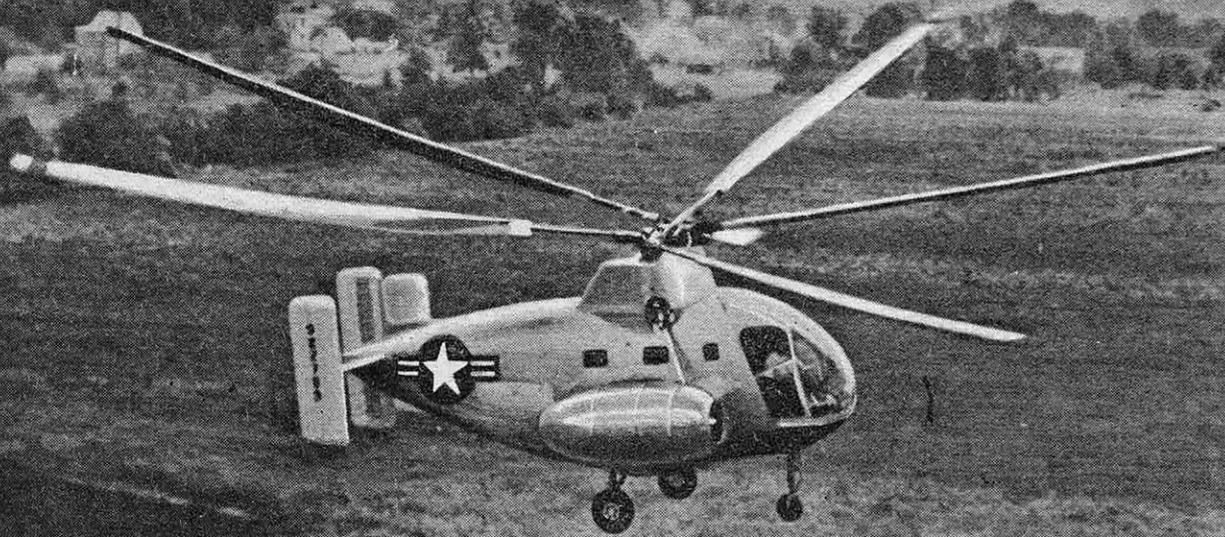
KELLETT XR-10. C'est un hélicoptère de transport à deux rotors engrenants de 19,8 m de diamètre, entraînés par deux moteurs Continental de 525 ch. Il peut emporter douze personnes. Son poids total est de 5 000 kg et sa vitesse de 190 km/h.
