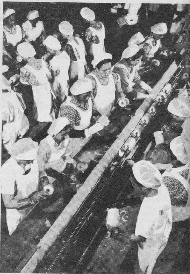
Les fruits, découpés en cylindres de dimensions standard, subissent un premier contrôle de qualité avant découpage.
