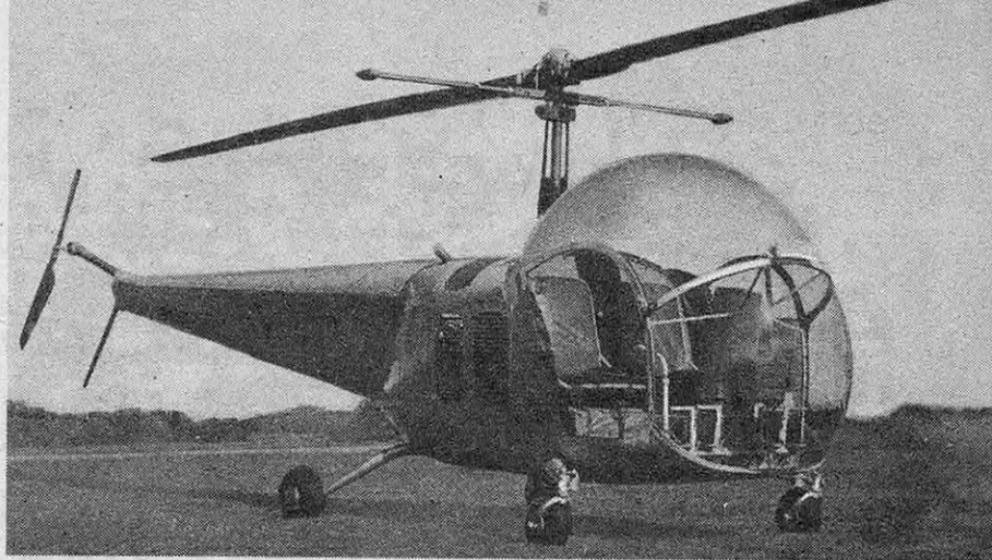
BELL 47-D. Rotor bipale de 10,7 m de diamètre stabilisé par une barre gyroscopique. Poids : 1000 kg. Moteur Franklin de 178 ch. Vitesse : 150 km/h. Appareil biplace.
