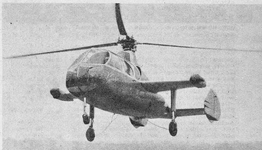
FAIREY « Girodyne ». Son hélice anticouple est latérale et sert à la propulsion. Le rotor a 15,9 m de diamètre. Poids : 2 040 kg. Puissance : 505 ch. Vitesse : 200 km/h.
