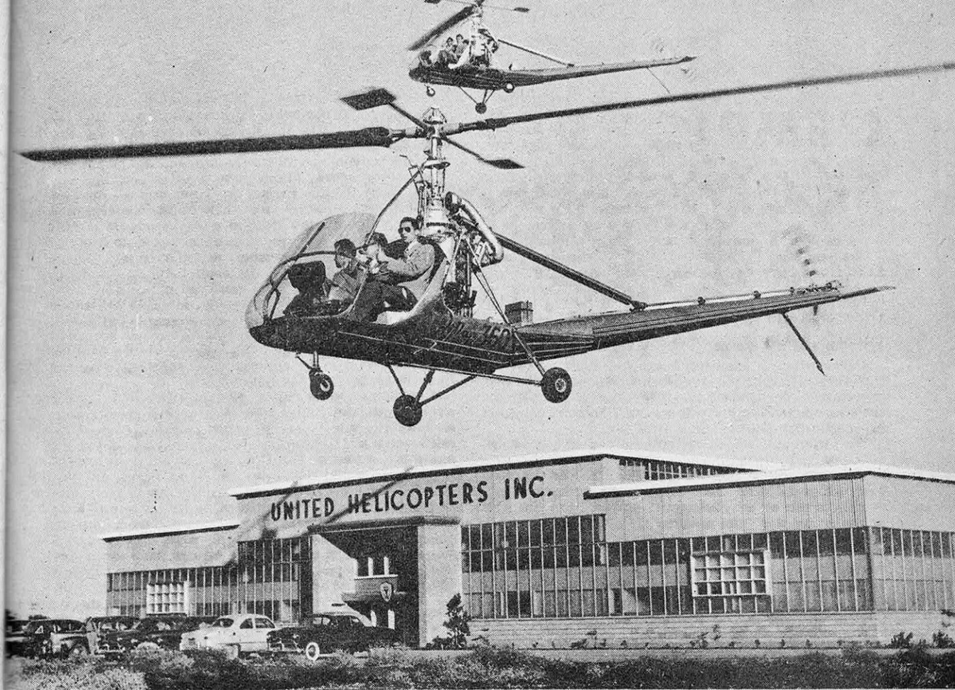
HILLER 360. Hélicoptère monorotor à hélice arrière anticouple et barre de stabilisation gyroscopique. Cet engin triplace a un rotor de 10,4 m de diamètre entraîné par un moteur Franklin de 178 ch. Poids total : 960 kg. Vitesse : 175 km/h.
