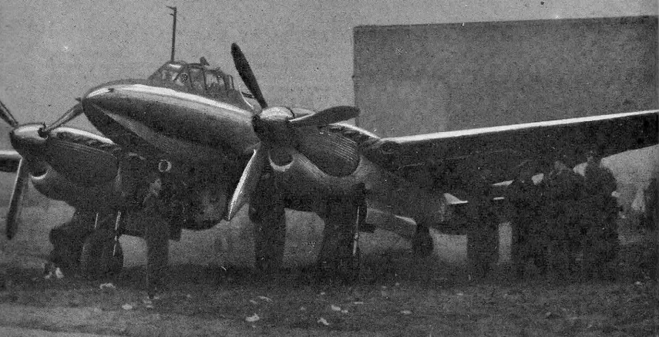
Le bombardier et avion d'assaut Petlyakov PE-2, conçu en 1940, est notamment en service en Pologne, Tchécoslovaquie et Yougoslavie. Il est destiné au bombardement en piqué, à l'assaut, à la reconnaissance et à la chasse de nuit. Équipé de deux moteurs M-105 R de 1 100 ch, sa vitesse maximum est de 540 km/h à 5 000 m. Voici quelques-unes de ses caractéristiques : envergure, 17,16 m ; longueur : 12,6 m ; poids total : 7 670 kg. ; rayon d'action : 1 770 km ; équipage : trois hommes.
