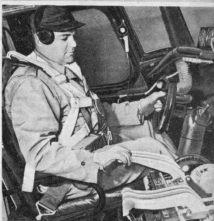
Le pilote Fisher actionnant les leviers qui commandent le renversement du pas des hélices de son Douglas DC-4.
