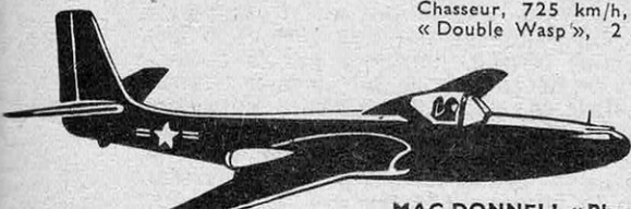
MAC-DONNELL « Phantom » Chasseur, 870 km/h, 4,5 t, 2 réact. 19 B, pouss. 1 250 kg.
