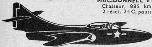
GRUMMAN « Panther » Chasseur, 900 km/h, 1 réact. « Nene », pouss. 2 270 kg.
