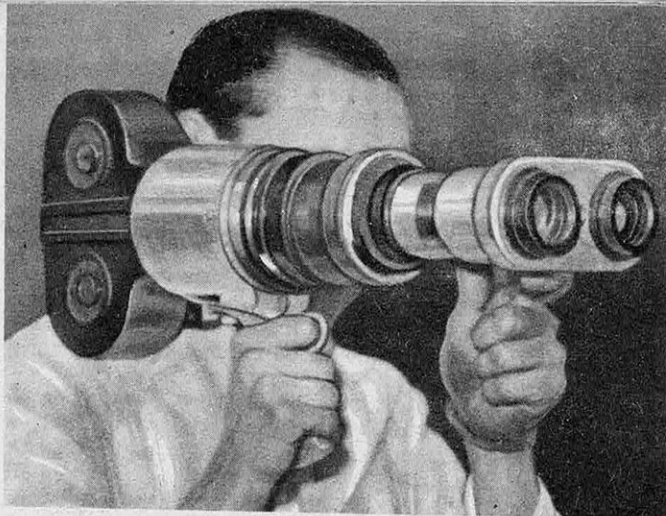
Fig. 4 : L'objectif de prise de vues, monté sur un appareil portable Bell et Howell, destiné aux reportages.
