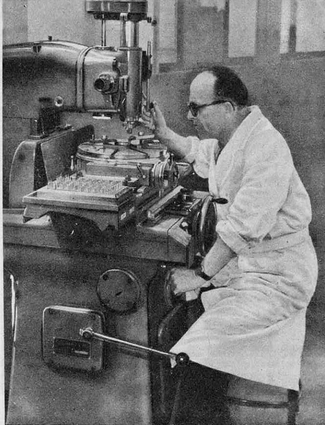
2 La machine à pointer, percer, aléser, permet d'effectuer ces opérations pour la confection de l'outillage avec une précision de 1/1000 de mm. (Lip.)
