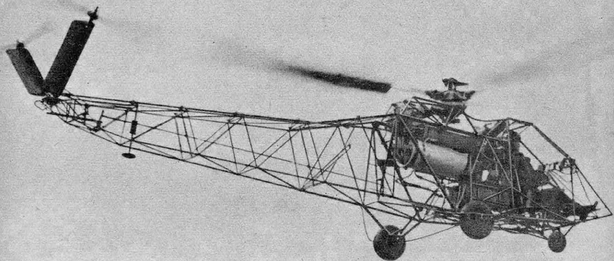
Fig. 3 : Le S. E. 3101 en vol. — La vitesse maximum horizontale est 129 km/h, la vitesse ascensionnelle 4,3 m/s, et la vitesse de chute verticale, en autogire, 8 m/s. Le plafond est 700 m en montée verticale, 3 000 m en montée oblique. 283
