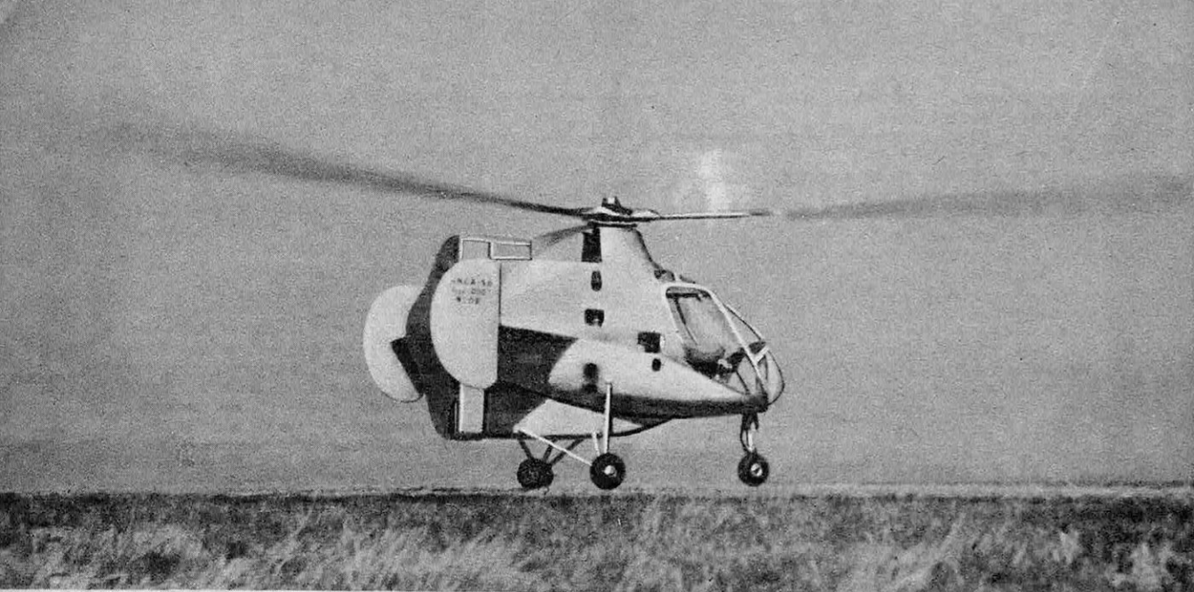
Fig. 6 : Le giravion S. O. 1100 « Ariel ». — Cet appareil fonctionne au décollage comme hélicoptère, en vol comme autogire. Rotor tripale à réaction de 10 m de diamètre, moteur Mathis G-7 de 170 ch, poids en charge 770 kg.
