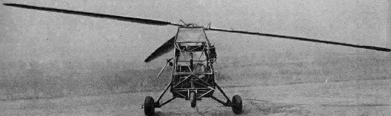
Fig. 1 : L'hélicoptère S. E. 3101 au sol. — Cet appareil expérimental est équipé d'un moteur Mathis G 4 R de 99 ch. Le rotor principal, tripale, a 7,50 m de diamètre. Le poids total, pilote compris, est de 520 kg. Train tricycle non rétractable.
