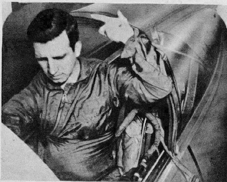
260 Fig. 1 et 2 : Un scaphandre d'altitude en nylon. — Dès que l'accélération dépasse une certaine valeur, de l'air sous pression pénètre entre les deux épaisseurs de ce vêtement, comprimant le ventre et les jambes du pilote (à droite).
