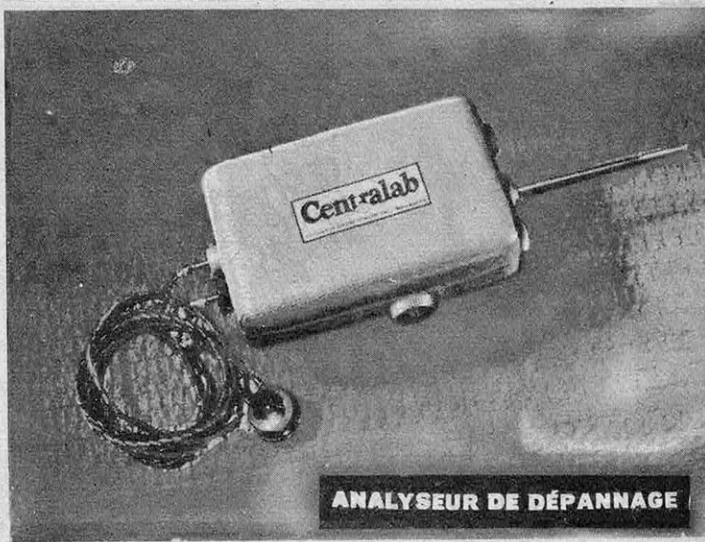
Fig. 5 : Quelques appareils de format très réduit réalisés à l'aide de circuits imprimés et de lampes miniatures.
