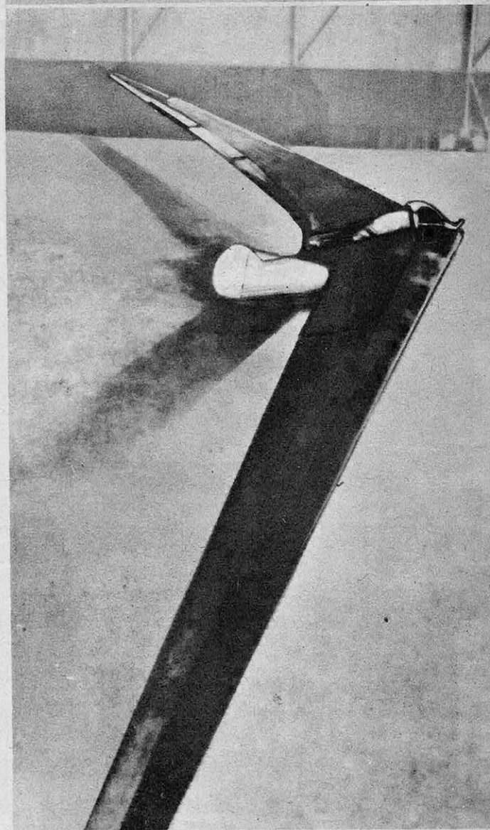
Fig. 5 et 6 : Le planeur Horten-6. — Les frères Horten ont construit en Allemagne avant et pendant la guerre de nombreux planeurs et avions sans queue, certains de très grande envergure. La photographie du haut montre la position couchée du pilote dans le planeur Horten-6, 263
