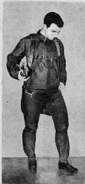
260 Fig. 1 et 2 : Un scaphandre d'altitude en nylon. — Dès que l'accélération dépasse une certaine valeur, de l'air sous pression pénètre entre les deux épaisseurs de ce vêtement, comprimant le ventre et les jambes du pilote (à droite).
