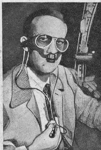
FIG. 11. — ENSEMBLE D'UN ÉQUIPEMENT ULTRALÉGER POUR PILOTE D'AVION COMPRENANT LES NOUVEAUX ÉCOUTEURS-MINIATURES, UN MICROPHONE FIXÉ SUR LA LÈVRE SUPÉRIEURE ET, ATTACHÉ À LA CRAVATE, UN DISPOSITIF DE RÉGLAGE DU VOLUME SONORE DES ÉCOUTEURS
