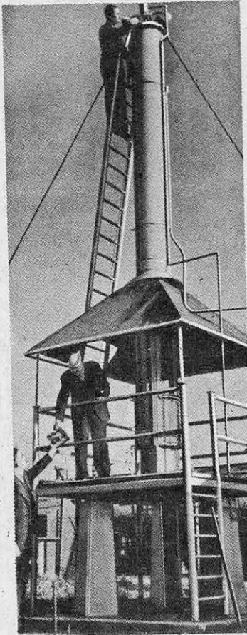
FIG. 8. — LE MORTIER « g » QUI PERMET D'OBTENIR DES ACCÉLÉRATIONS DE L'ORDRE DE CENT FOIS L'INTENSITÉ DE LA PESANTEUR
