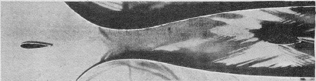
FIG. 4. — ÉCOULEMENT AUTOUR D'UN PROFIL FUSÉLÉ EN RÉGIME SUBSONIQUE (A GAUCHE) ET SUPERSONIQUE (A DROITE) Il s'agit d'une représentation par un courant d'eau dans un canal à surface libre. On distingue nettement, à droite, les ondes de choc en régime supersonique. (Brown Boveri).
