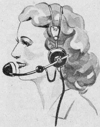
FIG. 9. — LE CASQUE DE LA « BELL TELEPHONE COMPANY » PORTANT SON MICROPHONE
