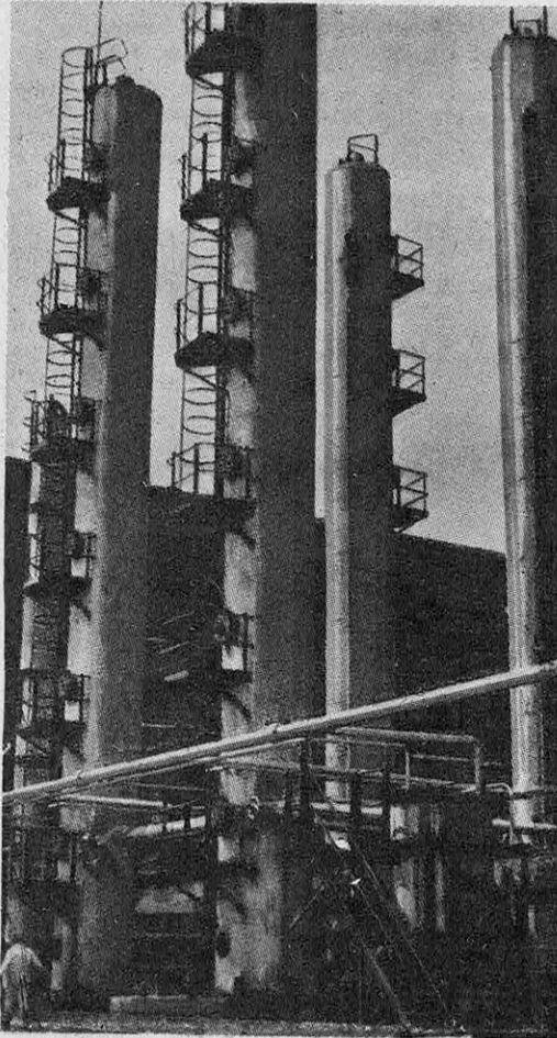
FIG. 6. — TOURS DE PURIFICATION DE L'AIR DESTINÉ AUX CUVES DE FERMENTATION EN PROFONDEUR, AUX USINES DE SPEKE (GRANDE-BRETAGNE)
