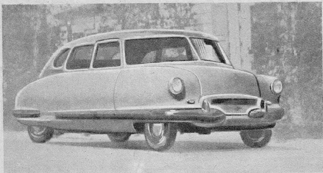
FIG. 7. — LA VOITURE DONT LE CHASSIS ET LA CAISSE SONT EN VERRE
