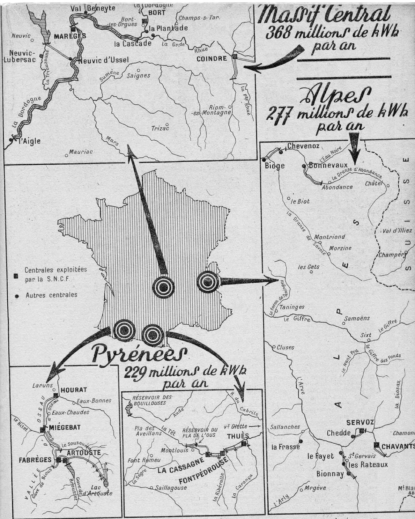
FIG. 4. — LES GRANDES RÉGIONS FRANÇAISES RICHES EN HOUILLE BLANCHE OU LA S. N. C. F. POURSUIT L'AMÉNAGEMENT HYDROÉLECTRIQUE. LES CHIFFRES INDIQUENT LA PRODUCTION D'ÉNERGIE SUPPLÉMENTAIRE DESTINÉE À L'ALIMENTATION DES 2 000 KM DE VOIES DONT L'ÉLECTRIFICATION EST PRÉVUE DANS LE PROGRAMME DÉCENNAL 1946-1955
