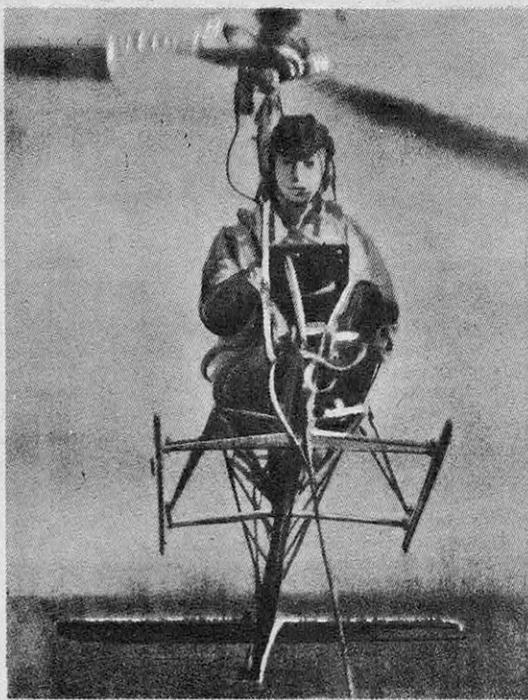
FIG. 7. — UN CERF-VOLANT AUTOGIRE D'OBSERVATION UTILISÉ PAR LES SOUS-MARINS ALLEMANDS
